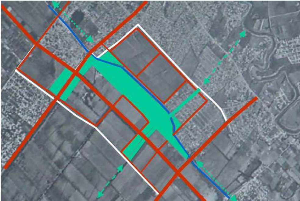
Figura 4-9 Esquema da definição das cargas ou sistemas públicos (em vermelho as vias e em verde os parques e praças).
