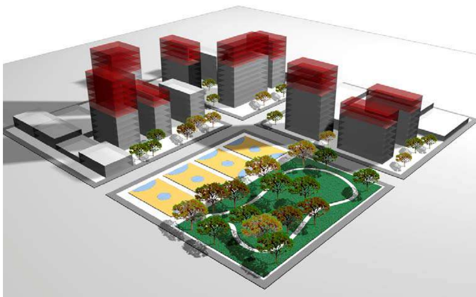
Figura 1-2 Esquema conceitual do Solo Criado. Em vermelho o potencial adicional de construção. A praça é exemplificada como objeto de contrapartida exigida em função do ônus gerado na infra-estrutura.
