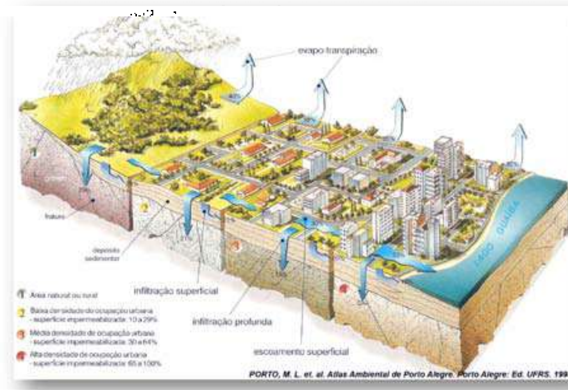
FIGURA 14 – ESQUEMA DO CICLO DA ÁGUA CONFORME TAXA DE PERMEABILIDADE FONTE: PORTO (1994)
