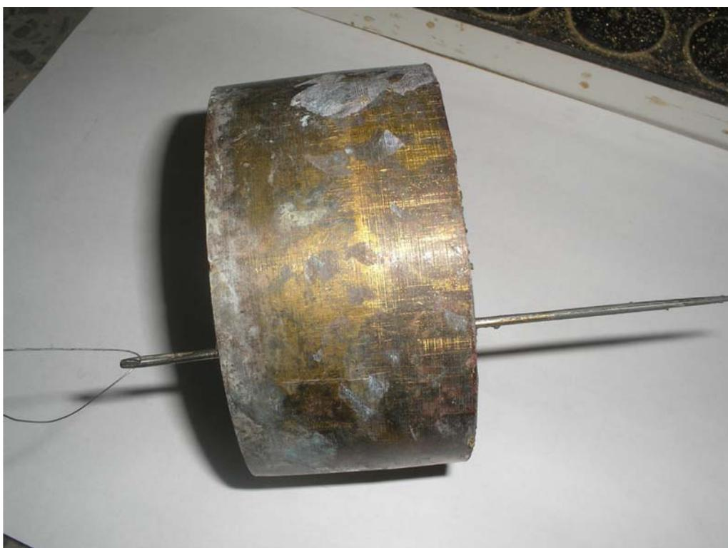
*Figura 5.20 Passando a agulha e o fio de aço na interface solo-tubo amostrador.*
