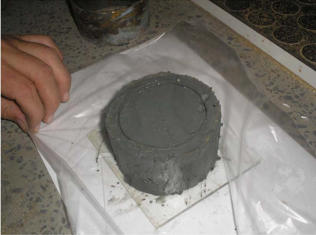
*Figura 5.21 Segmento de amostra extraída com anel de adensamento já cravado.*
