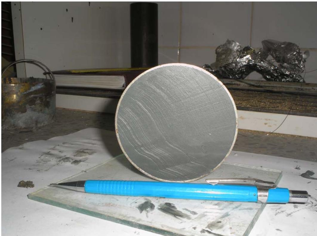
Figura 5.24 Corpo de prova pronto para ser montado na célula de adensamento.
