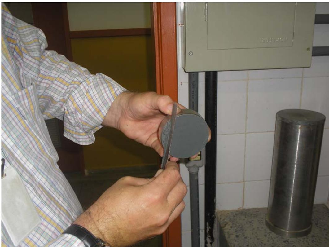
Figura 5.23 Regularizando as superfícies superior e inferior do corpo de prova.
