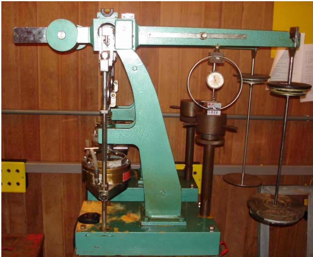
*Figura 5.144 Montagem usada nos ensaios de relaxação imperfeita de tensões.*
