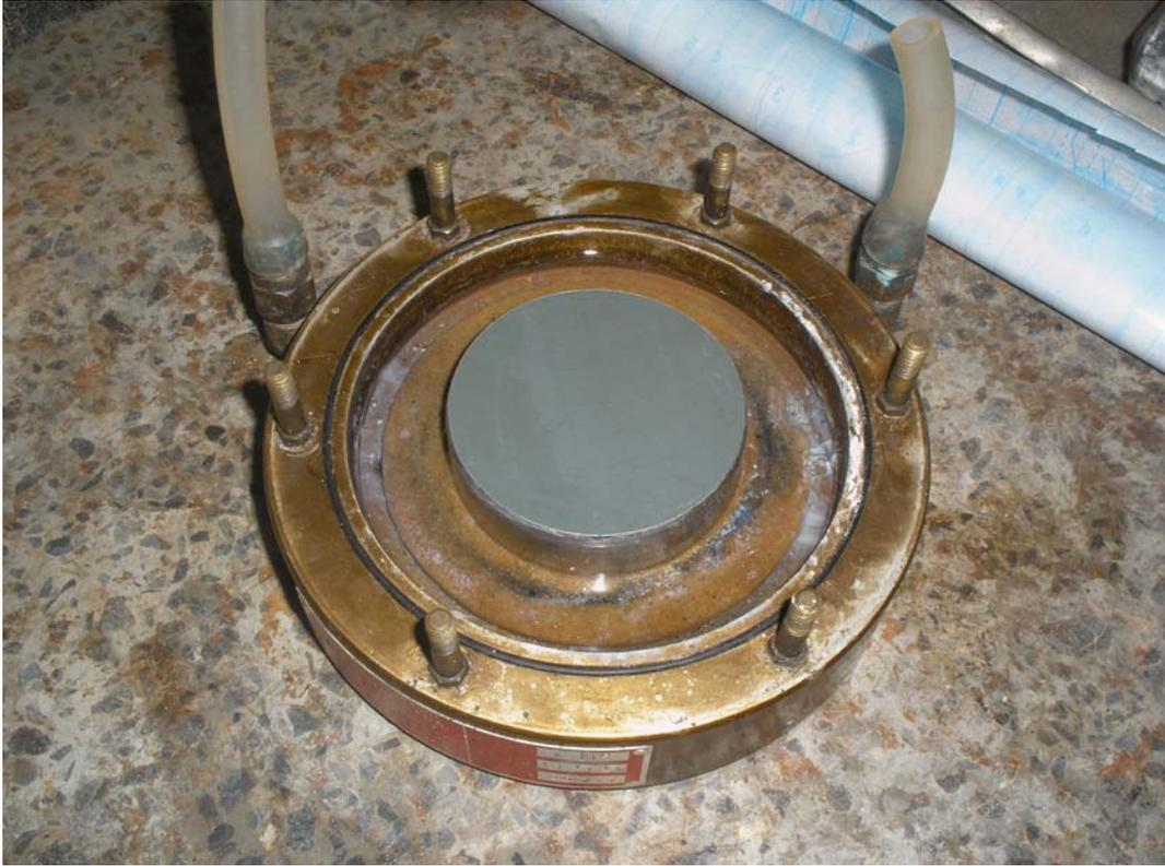
*Figura 5.25 Corpo de prova posto na célula de adensamento.*
