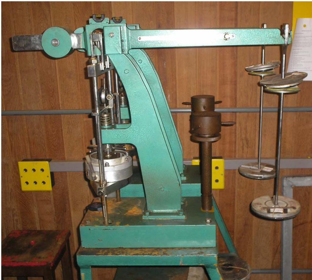
*Figura 5.18 Equipamentos utilizados nos ensaios de adensamento convencionais.*
