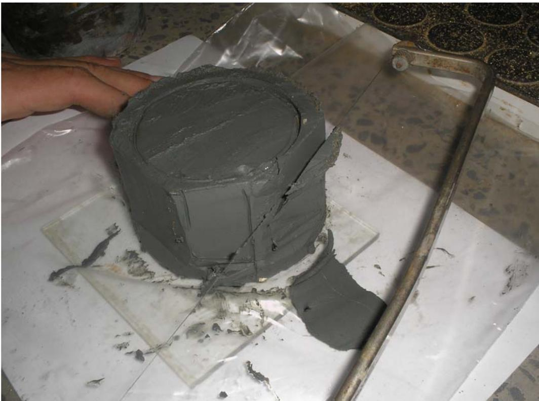
*Figura 5.22 Aparando a porção de solo que excede as dimensões do anel.*
