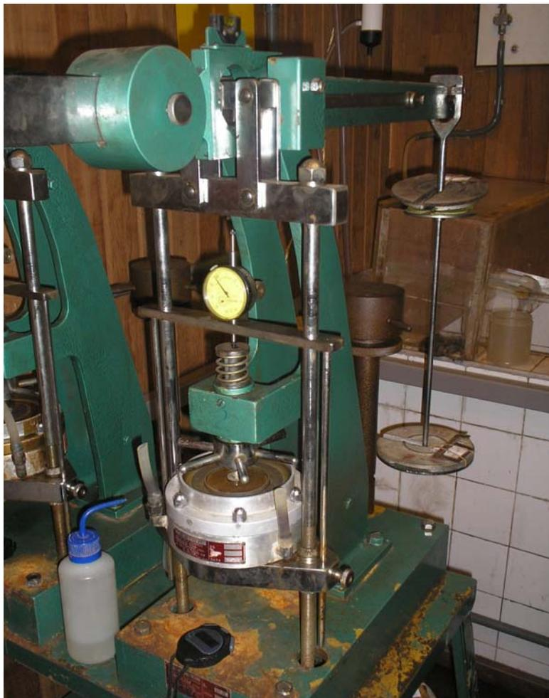
*Figura 5.28 Célula montada na prensa com ensaio em andamento.*
