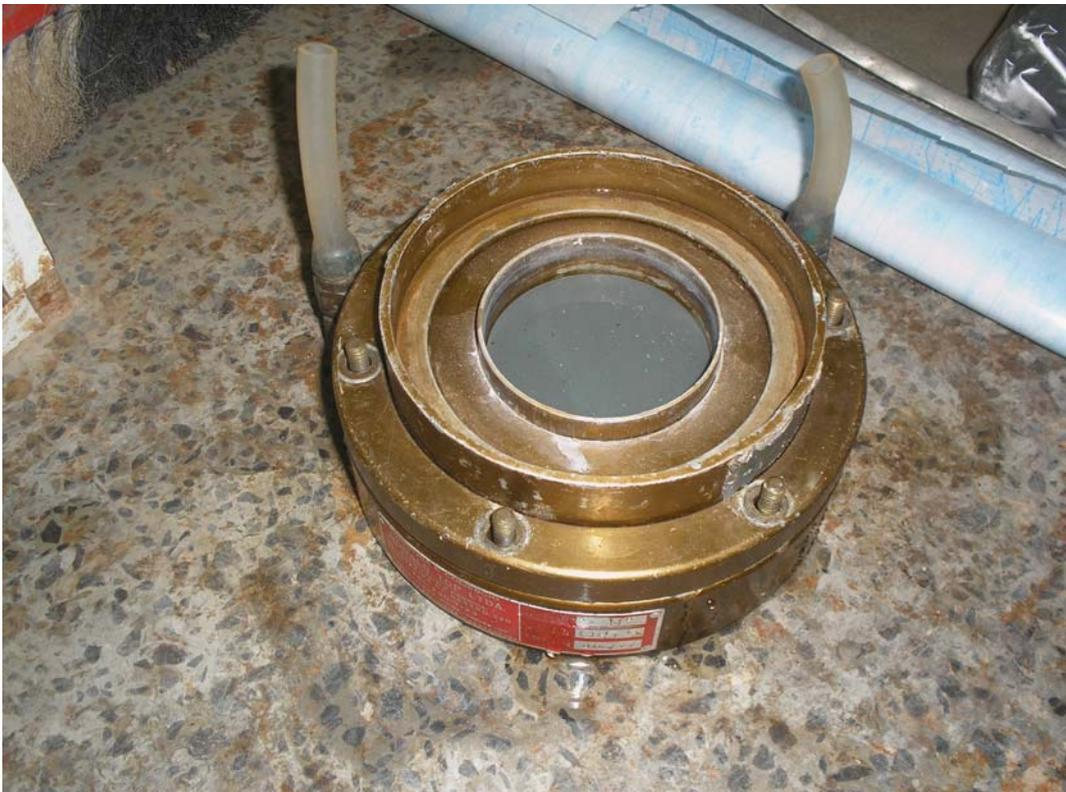
*Figura 5.26 Colocação da parte superior da célula e do colarinho centralizador.*
