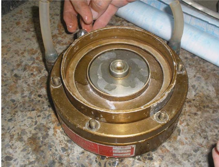
*Figura 5.27 Fechamento da célula e colocação do “top-cap”.*
