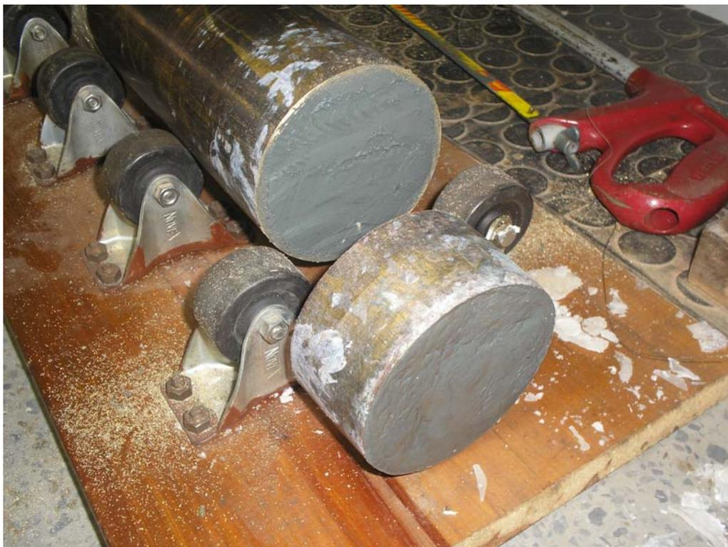
*Figura 5.19 Amostra destacada juntamente com segmento do tubo amostrador cortado.*
