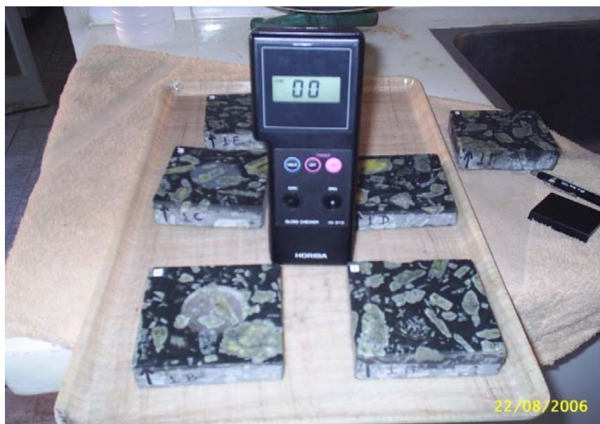
Figura 5. Ensaio que simula a alterabilidade induzida pelos processos naturais antropogênicos e de degradação sobre Diabásio porfírico. No centro o aparelho Gloss Meter usado para medir perda de brilho.
