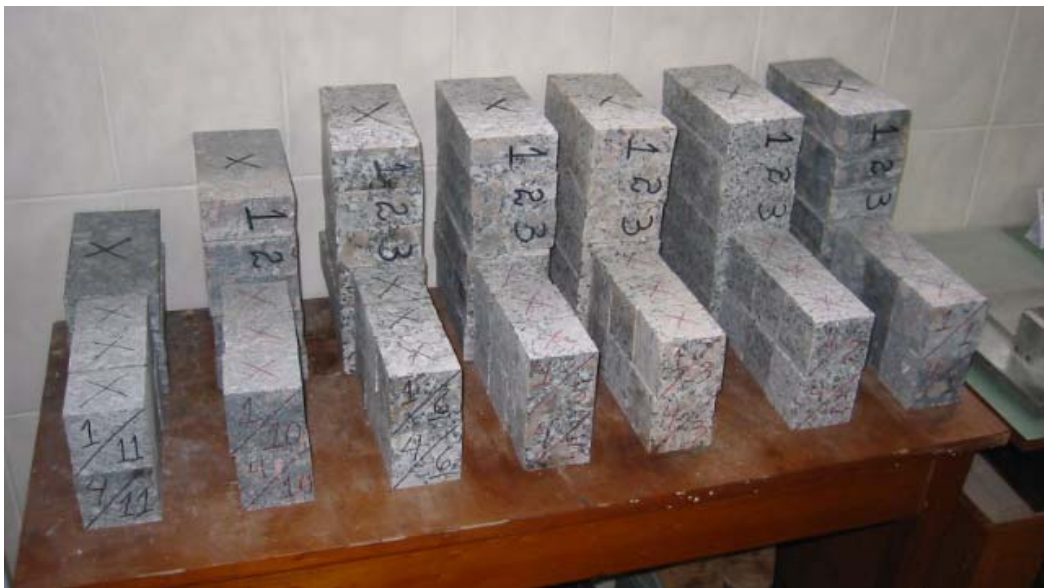
Figura 11. Preparação de corpos de prova no Laboratório de Rochas Ornamentais do DPM/IGCE, para ensaios de Compressão Uniaxial e Flexão 3 pontos.
