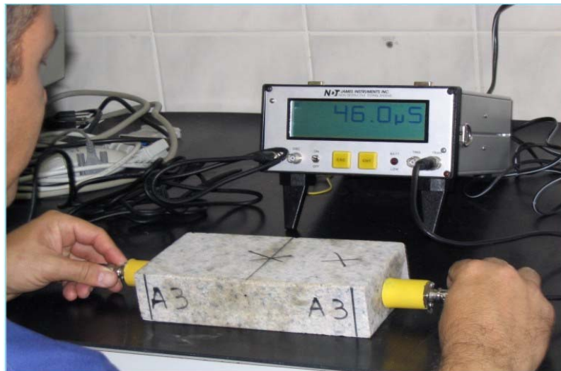
Figura 14 Equipamento utilizado para medir a velocidade ultra-sônica das rochas Laboratório de Caracterização Tecnológica de Rochas Ornamentais da UNESP.
