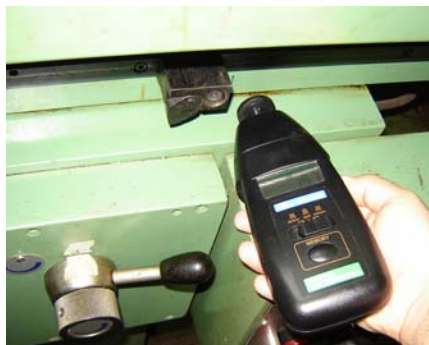
Figura 4.6 – Ajuste da velocidade tangencial da mesa com tacômetro ( V_w )
