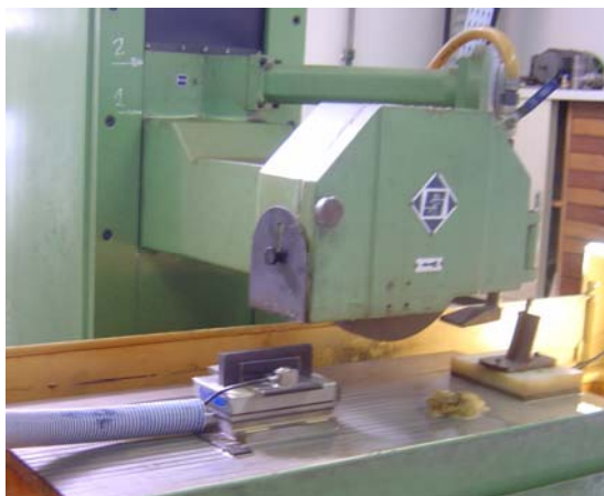
Figura 4.1 - Retificadora plana modelo RAPH - 1055, SULMECÂNICA
