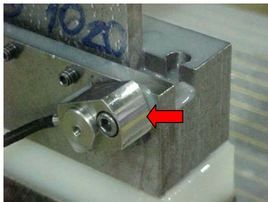
Figura 4.2 – Fixação do sensor de emissão acústica
