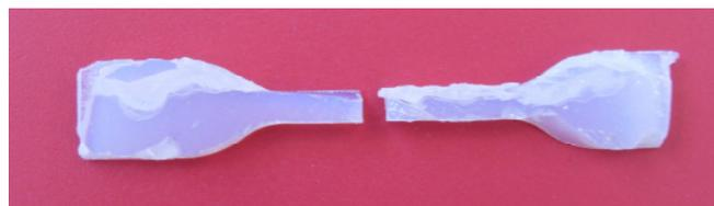
**Figura 15 – Corpo de prova do copolímero CS-A (30% PBA; 70% PS)
