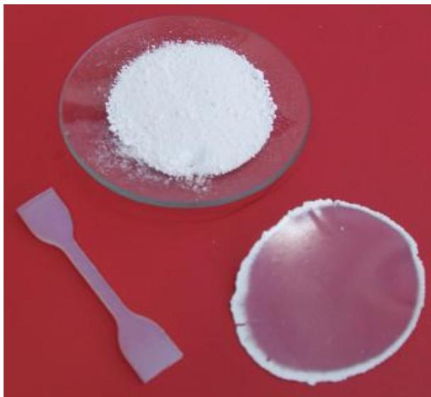
**Figura 19 – Copolímero CS-1 antes e após a sua moldagem por compressão**
