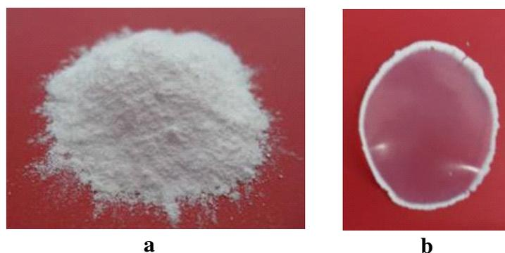
**Figura 13 – Copolímero CS-D (45% PBA; 55% PS) antes (a) e após (b) a sua moldagem por compressão**
