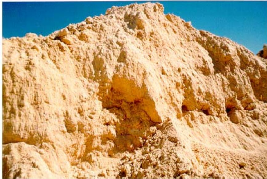
FIGURA 3.4 - Pilha de fosfogesso de uma indústria brasileira de fertilizantes.
