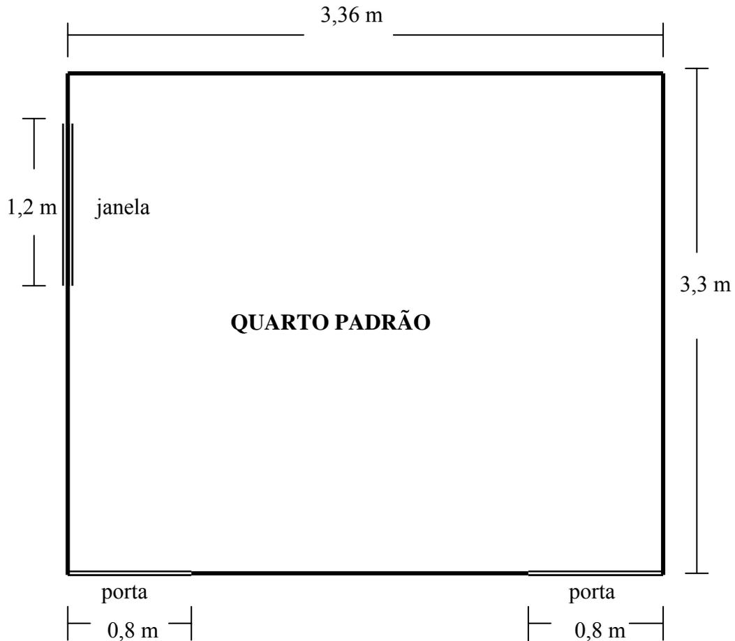
FIGURA 6.2 - Representação esquemática da planta do quarto padrão
