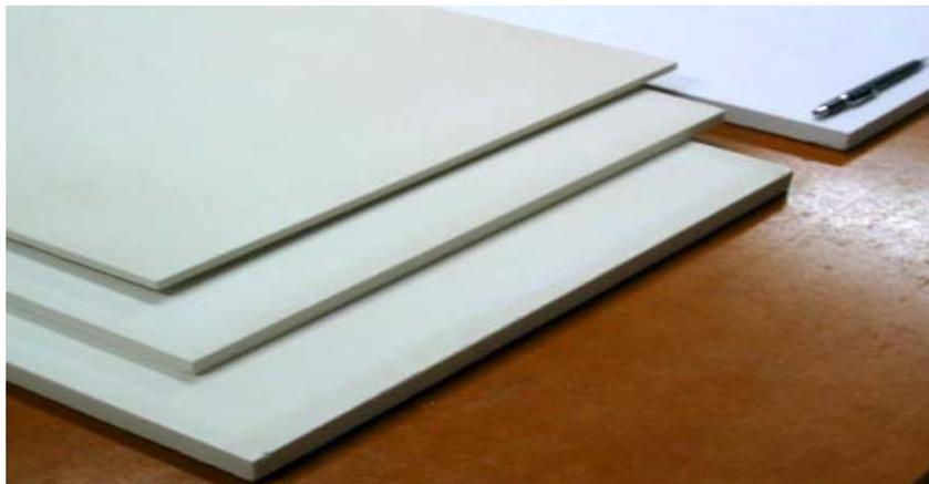
FIGURA 5.1 – Placas pré-fabricadas à base de fosfogesso.
