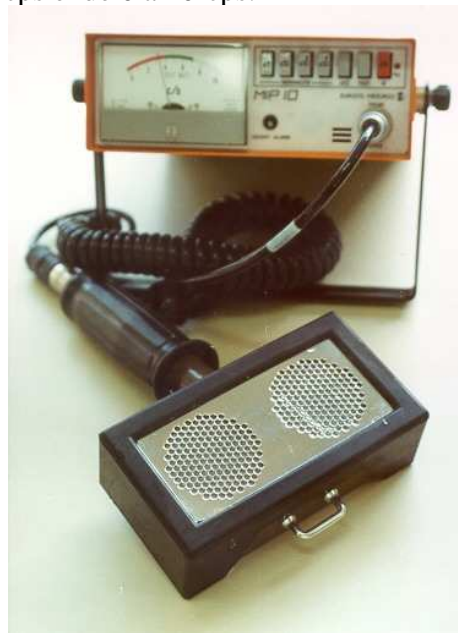
FIGURA 2.5 - Monitor móvel para contagem, modelo MIP 10
