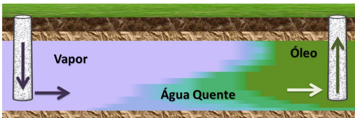
Figura 2.2 Injeção Contínua de Vapor
