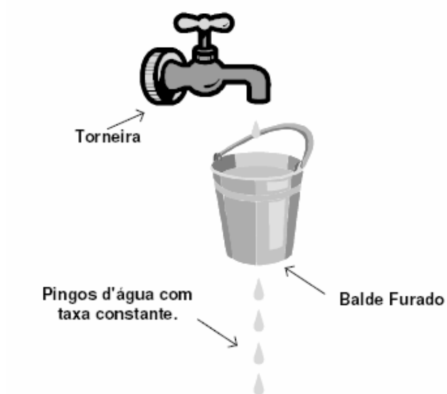
Figura 18: O método do balde furado – água
