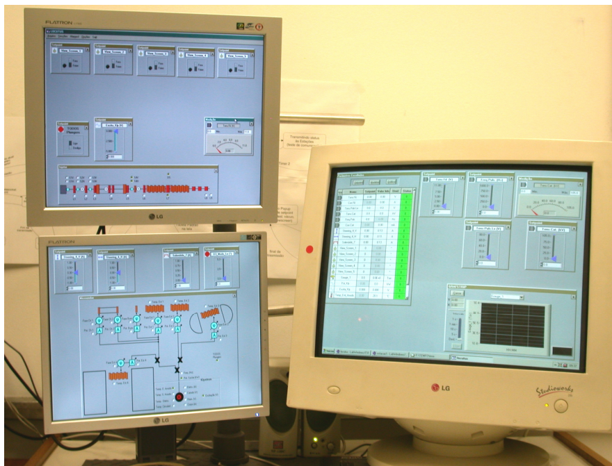
FIGURA 55 - Disposição dos vários monitores da IHC que compõe o console do operador.
