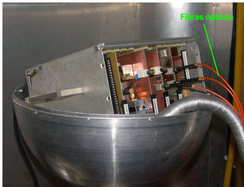
FIGURA 37 - Bastidor de controle do canhão alojado na semi-esfera sobre o terminal de alta tensão. Note as três fibras ópticas à direita.
