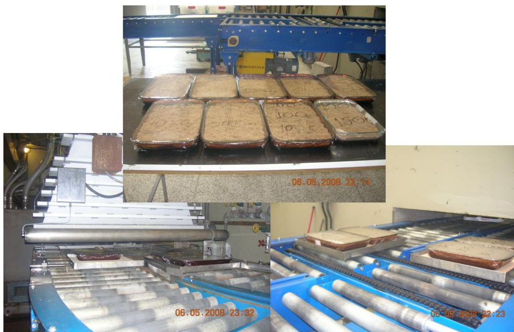
FIGURA 8. Sistema de irradiação de amostras no acelerador de feixe de elétrons
