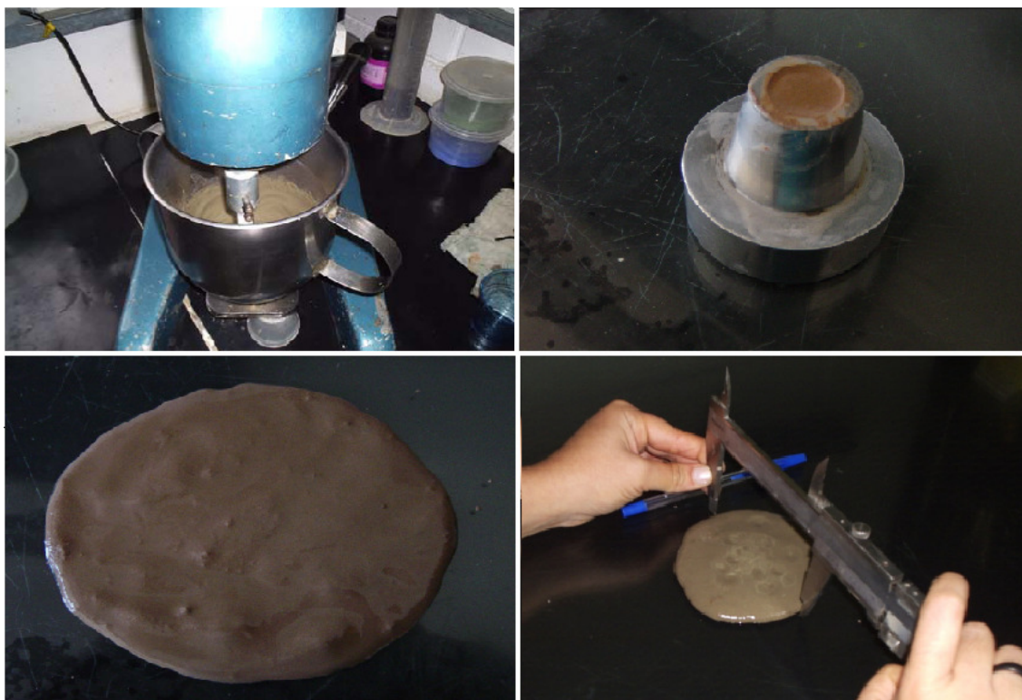
Figura 3.5 (a) Preparação da calda de solo-cimento; (b) Minitronco de cone preenchido com calda solo-cimento; (c) Pasta de solo-cimento espalhada sobre a placa de vidro; (d) Determinação de um dos diâmetros da calda de solo-cimento.
