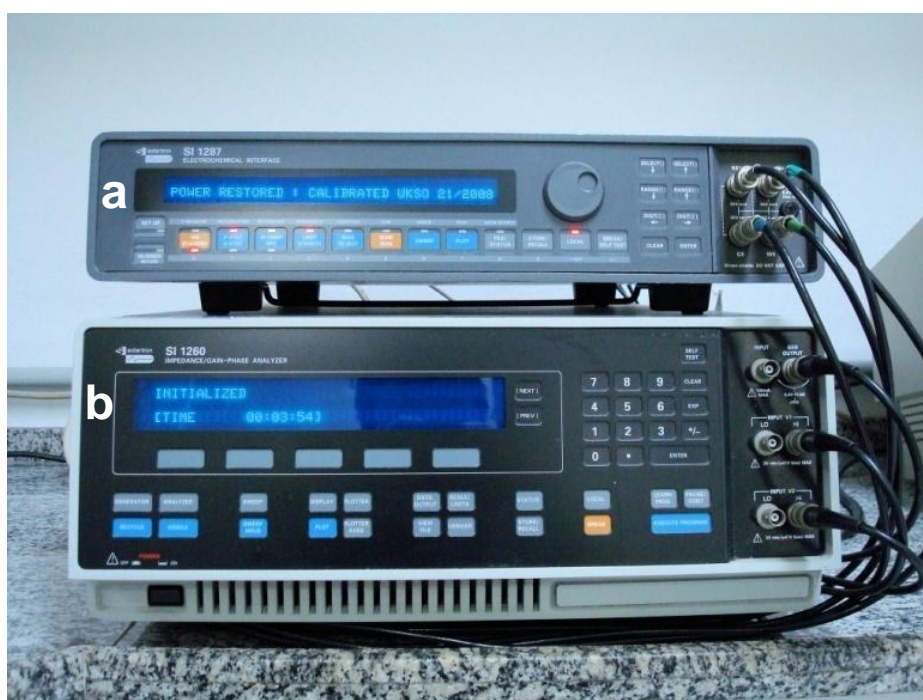
Figura 16 - Analisador de respostas em frequência Solartron 1260 (b) acoplado a um potenciostato Solartron 1287 (a).
