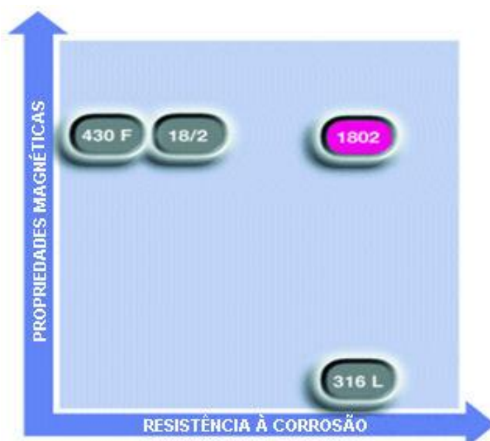
Figura 11 – Comparativo entre resistência à corrosão e propriedades magnéticas de diferentes aços. Fonte: General datasheet of precision wire 1802 - Sandvik
