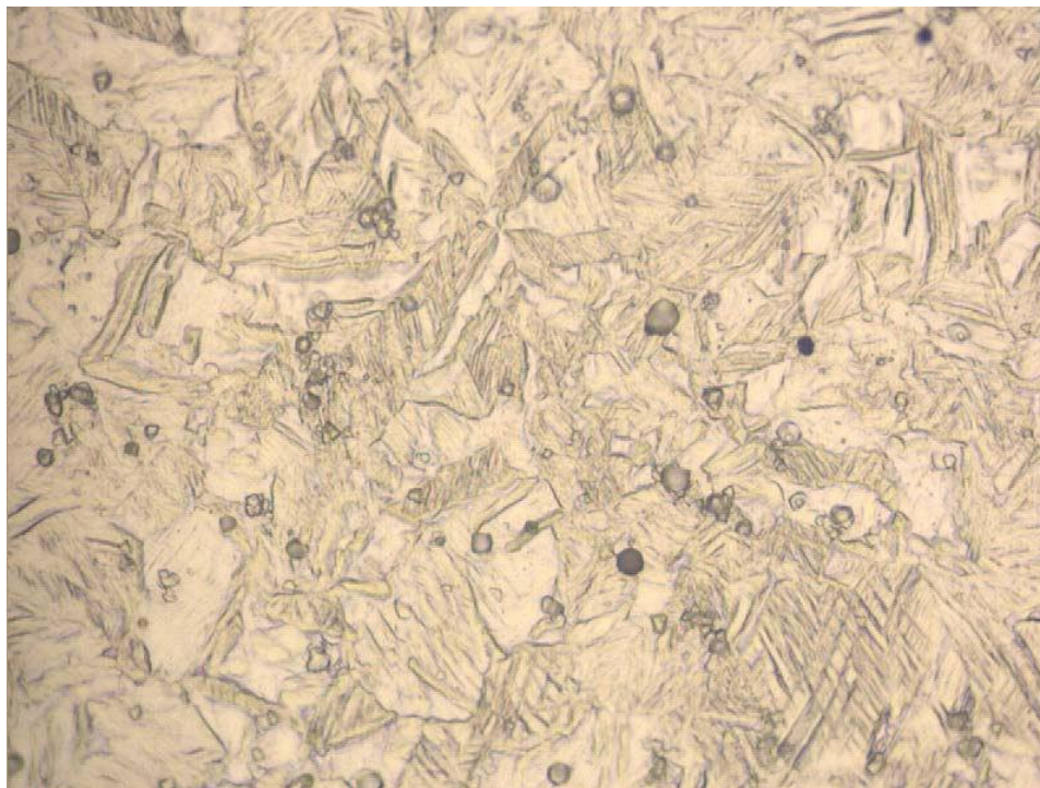
Figura 12 - Micrografia ótica da superfície do aço inoxidável 316L após ataque eletrolítico segundo procedimento 13b da norma ASTM E407-99. Fonte ANTUNES, 2006.
