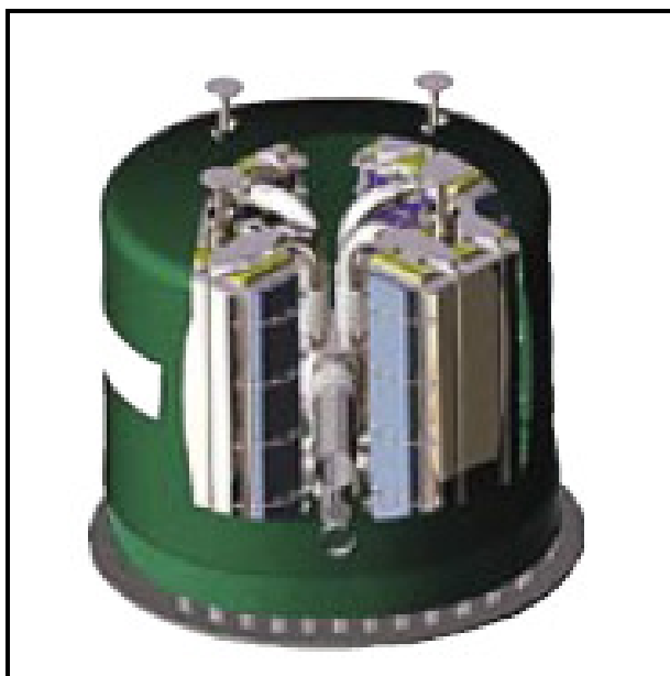
Figura 3-12 - Visão em corte de uma pilha MCFC
