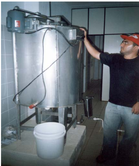
Figura 9 - Equipamento para purificação do mel Fonte: autora, dez/2004
