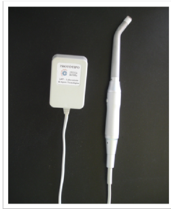
Figura 4 - Aparelho de LED (protótipo CePOF/IFSC/USP – São Carlos, SP) utilizado no estudo.
