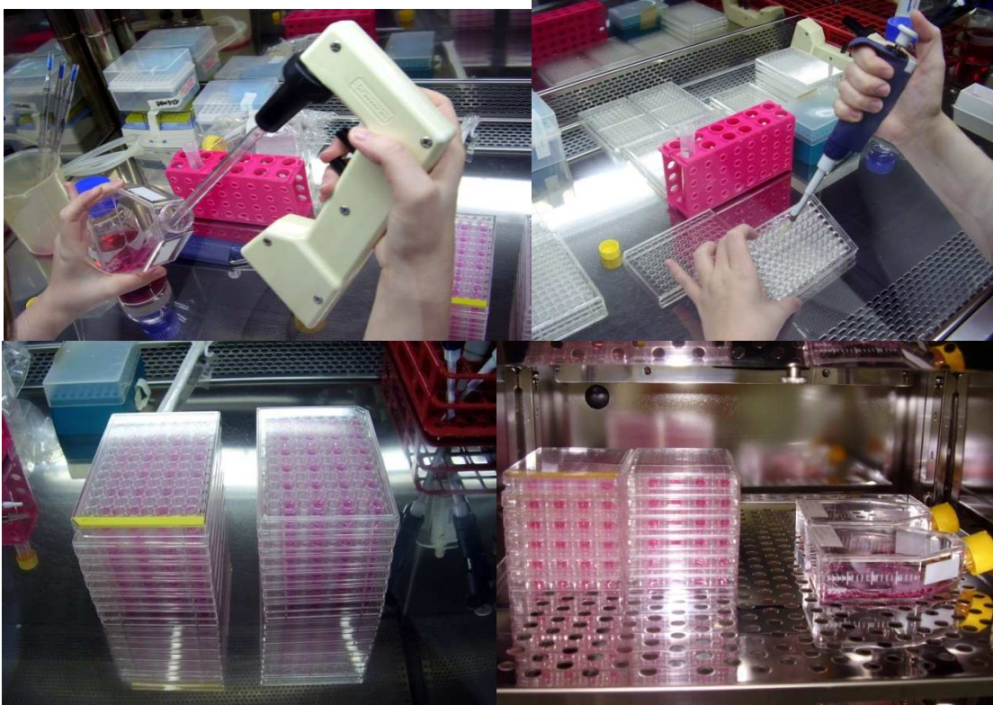
Figura 5 - Manipulação das culturas celulares em capela de fluxo laminar e disposição das placas de 96 poços e garrafas na estufa de CO 2 .
