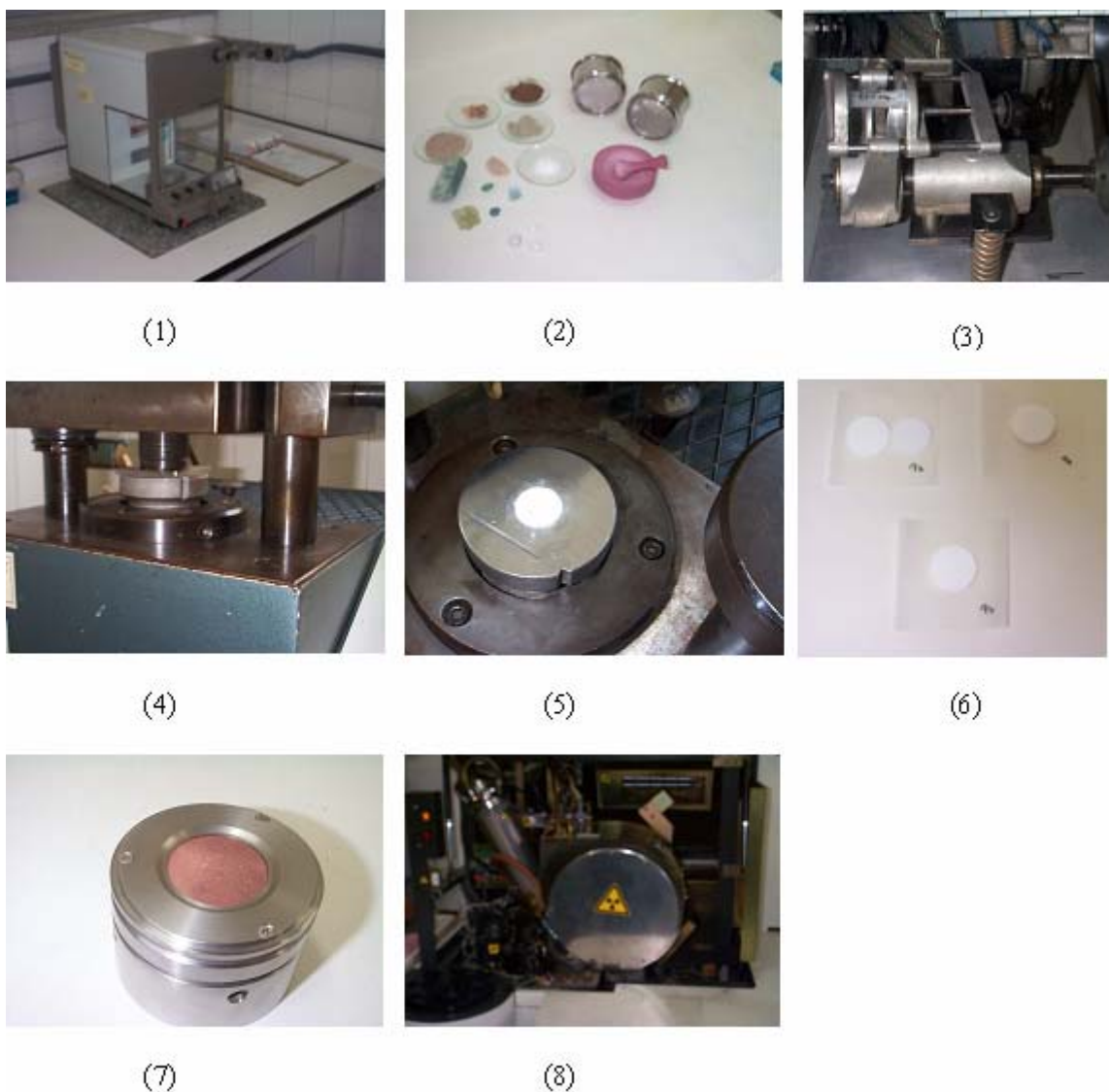
FIGURA 9 - Equipamentos utilizados e seqüência de operação na preparação das amostras na forma de pastilhas prensadas.
