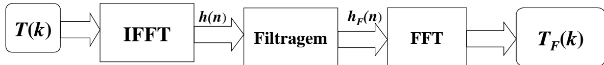
Figura 5.11 - Fluxograma para processamento da filtragem da medida T(k) .
