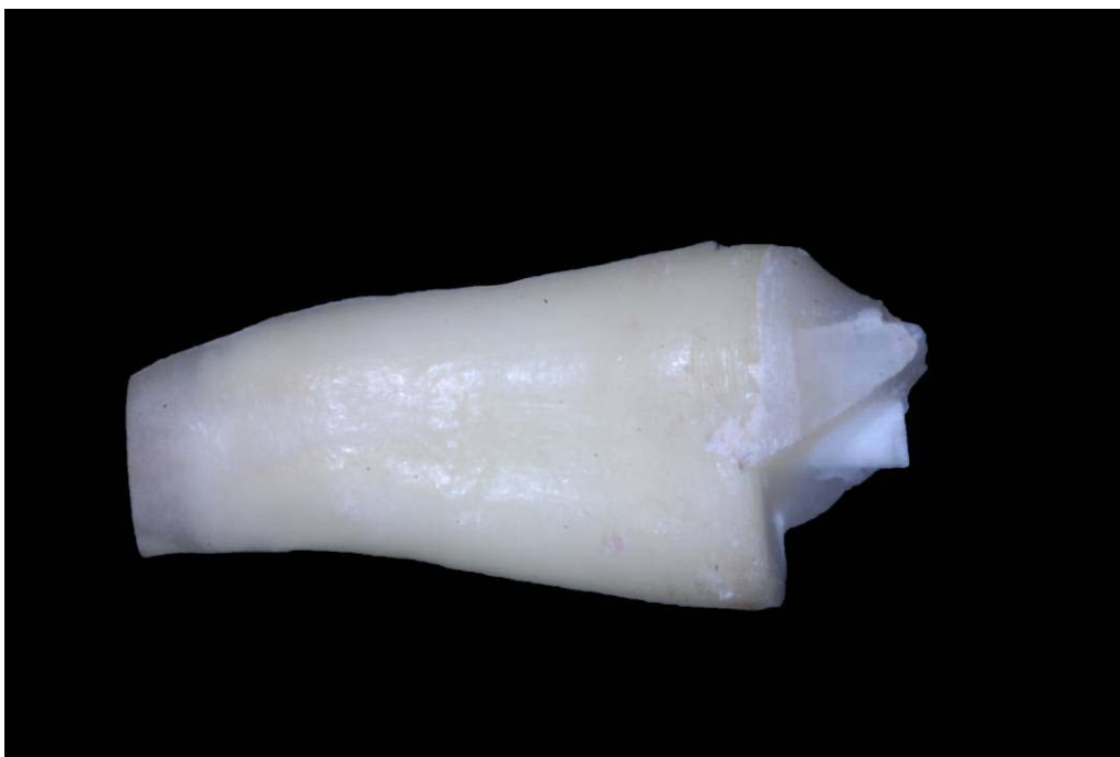
Figura 24 – Padrão mais comum de fratura ocorrido no G2. Pode-se observar que a falha ficou restrita ao munhão.
