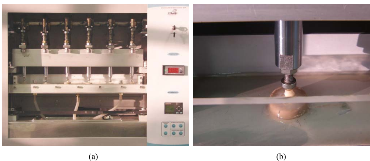
Figura 18 – Corpos de prova submetidos a ensaio de fadiga (a e b).
