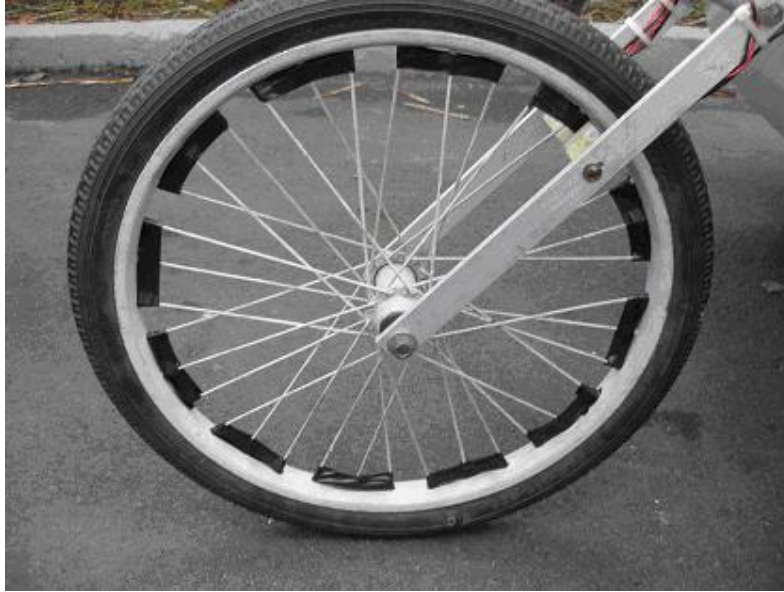
Fig 3.18 - Sistema utilizado para medição de distância percorrida e velocidade
