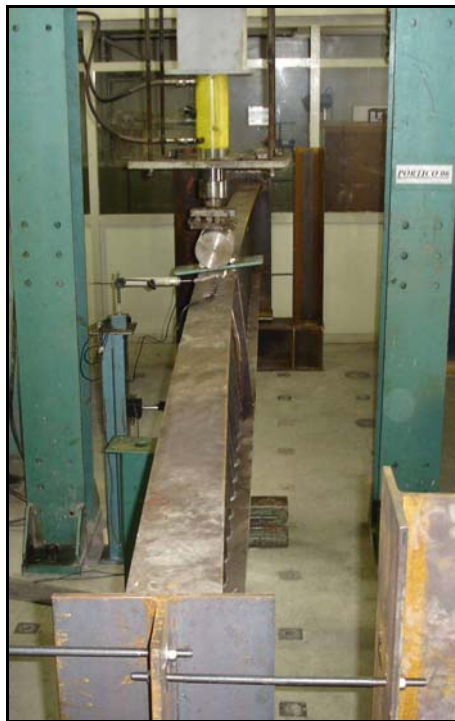
FIGURAS 4.24 – PSS 600x150x8x2x6000 sem travamento central após o ensaio
