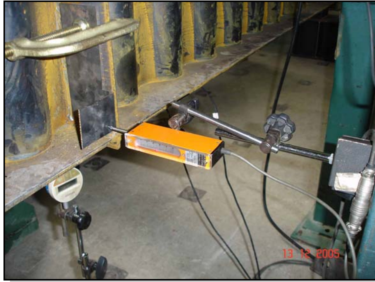
FIGURA 4.15 – Transdutor de deslocamento linear (DT 50 ) colocado a ½ do vão da viga, próximo à mesa inferior
