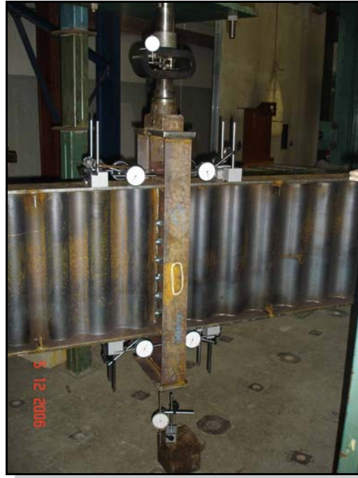
FIGURA 4.41 – Relógios comparadores nas mesas tracionada e comprimida
