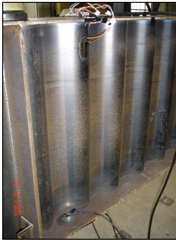
FIGURA 4.22 – Extensômetros elétricos de resistência (EER) na alma e na face interna da mesa inferior (lado esquerdo da viga) – seção central
