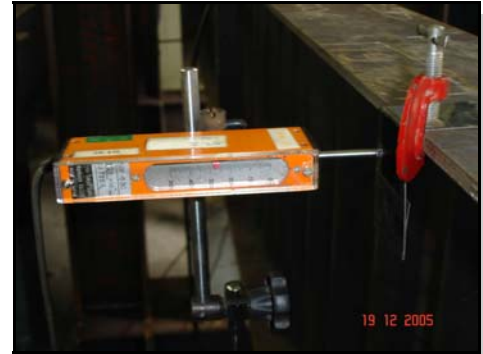
FIGURAS 4.19 – Transdutor de deslocamento linear (DT 50 ) colocado a \frac{1}{4} do vão do lado esquerdo da viga
