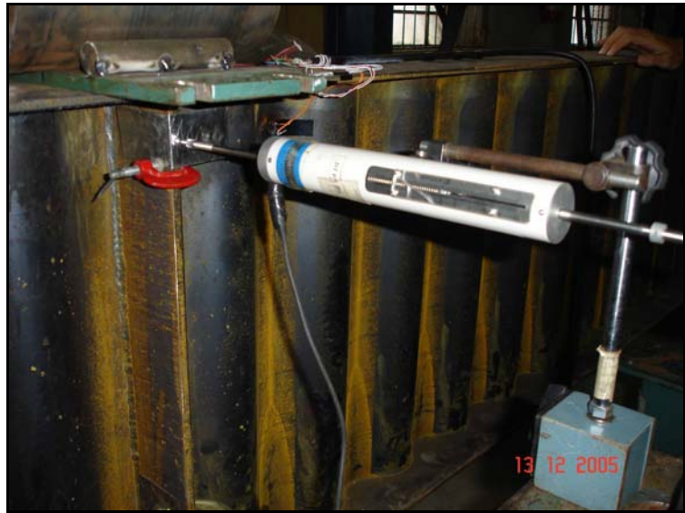
FIGURA 4.14 – Transdutor de deslocamento linear (DT 100 ) colocado a \frac{1}{2} do vão da viga, próximo à mesa superior
