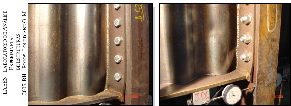
FIGURAS 4.44 – Protótipo 02 : Charneira plástica e deformação da alma
