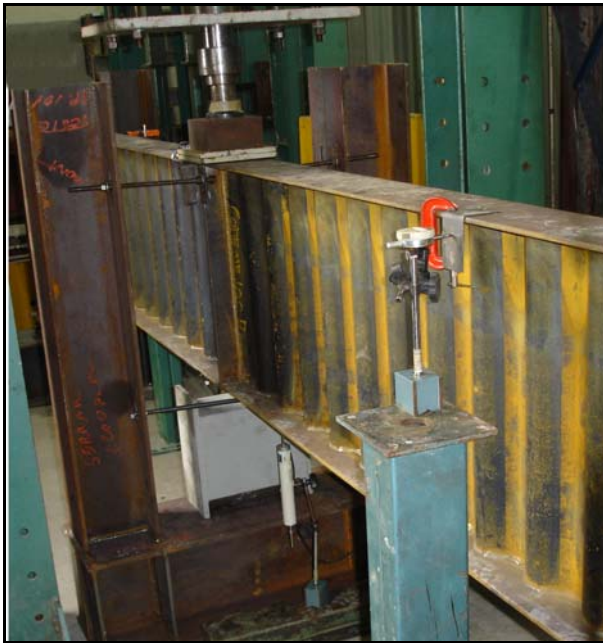
FIGURAS 4.20 – Relógio comparador de leitura digital (REC) colocado a \frac{1}{4} do vão do lado direito da viga
