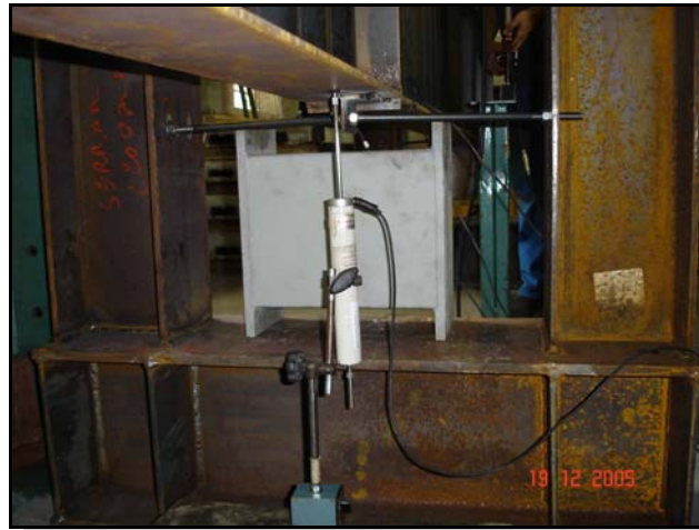
FIGURA 4.18 – Transdutor de deslocamento linear (DT 100 ) – seção central
