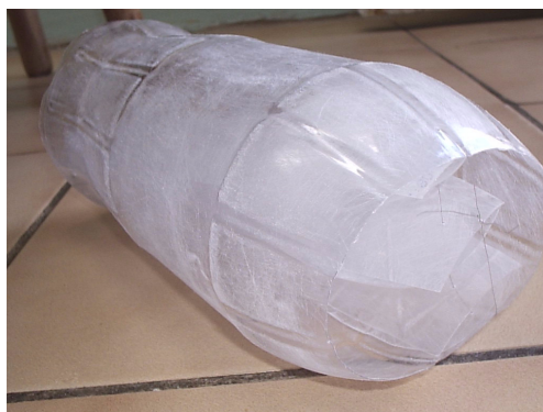
FIGURA 3.8 - MATERIAL SUPORTE FEITO DE GARRAFA PET
