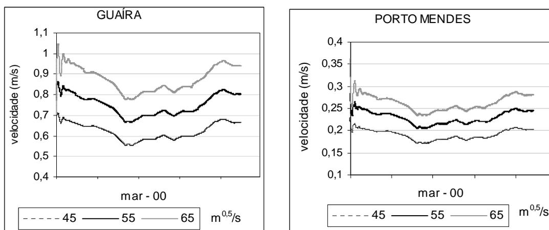
FIGURA 27: COMPARAÇÃO DE VELOCIDADE CONFORME A RUGOSIDADE.
