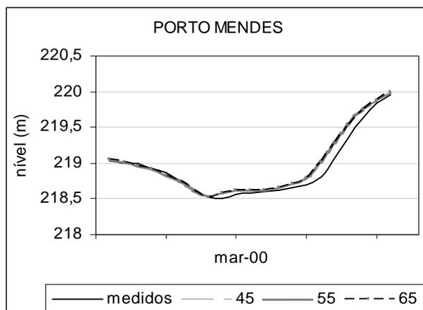
FIGURA 26: COMPARAÇÃO DE NÍVEIS CONFORME A RUGOSIDADE.
