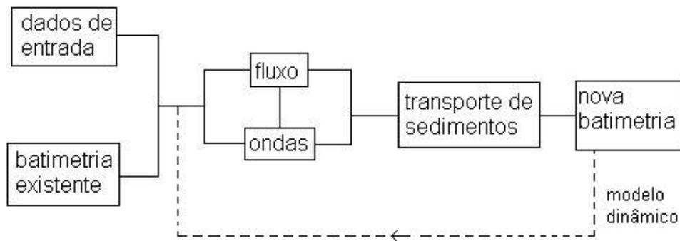
FIGURA 2: ESTRUTURA DE MODELOS INICIAIS E MORFOLOGICAMENTE DINÂMICOS<sup>6</sup>.
