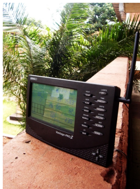
FIGURA 17 – Console de armazenamento dos dados da estação
