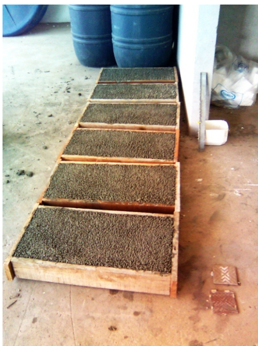
FIGURA 25 – Concretagem de 6 placas de concreto, processo de secagem e cura Fonte: Acervo Próprio
