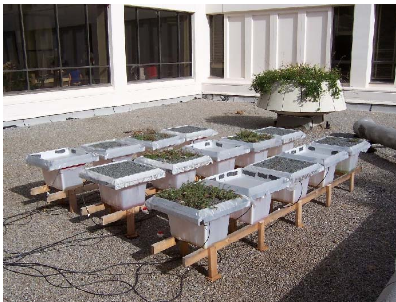
FIGURA 10 – Local de realização do monitoramento da retenção de água de módulos de telhado verde
