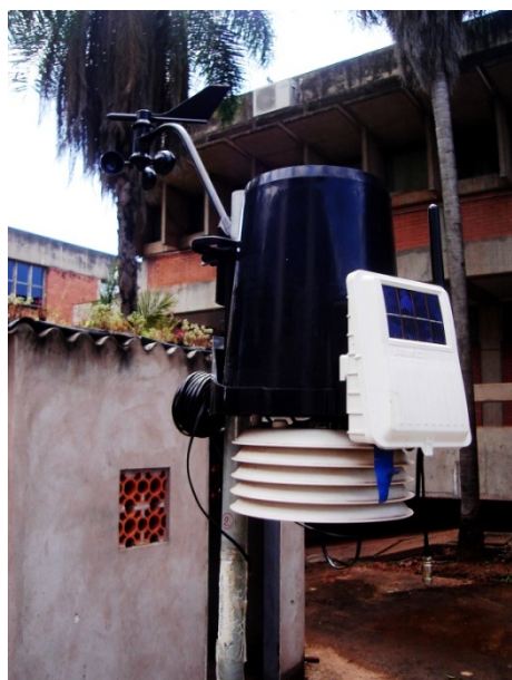
FIGURA 16 – Estação Meteorológica Automática
