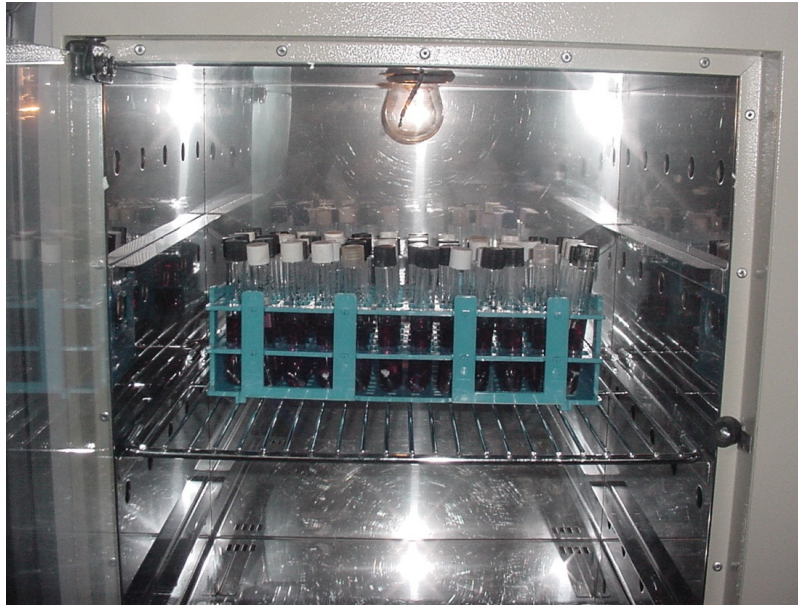
Figura 8. Estufa biológica Q-316M2. Visão interna com bandeja contendo os tubos de ensaio para encubação a 37°C.
