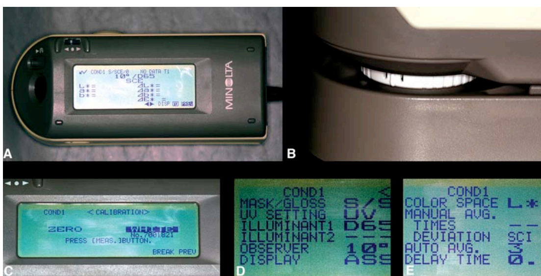
Figura 2. A – Espectrofotômetro Minolta CM 2600D utilizado nesta pesquisa. B e C – Calibração inicial do aparelho com auxílio de uma placa de calibração que acompanha o aparelho. D e E – Detalhe da regulação dos parâmetros de mensuração.
