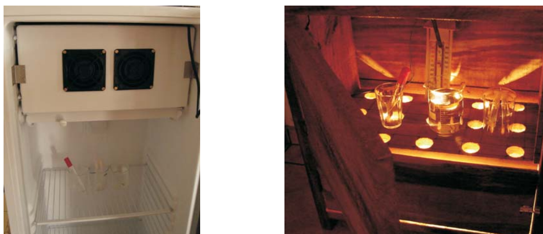
Figura 3 - Extruturas utilizadas para a estocagem dos ovócitos e do sêmen (câmara germinadora e estufa de madeira com termostato)
