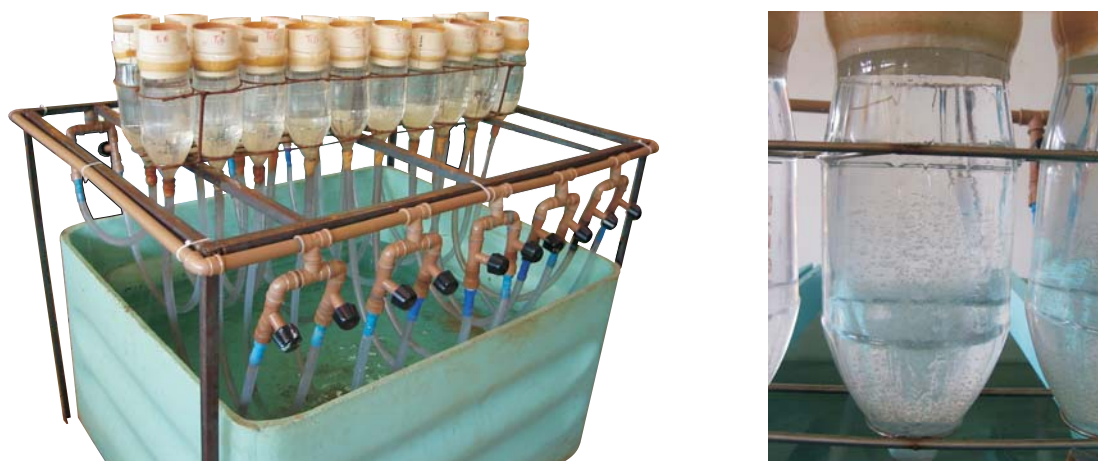
Figura 2 - Sistema de incubação com recirculação de água e incubadora experimental de 2,5L
