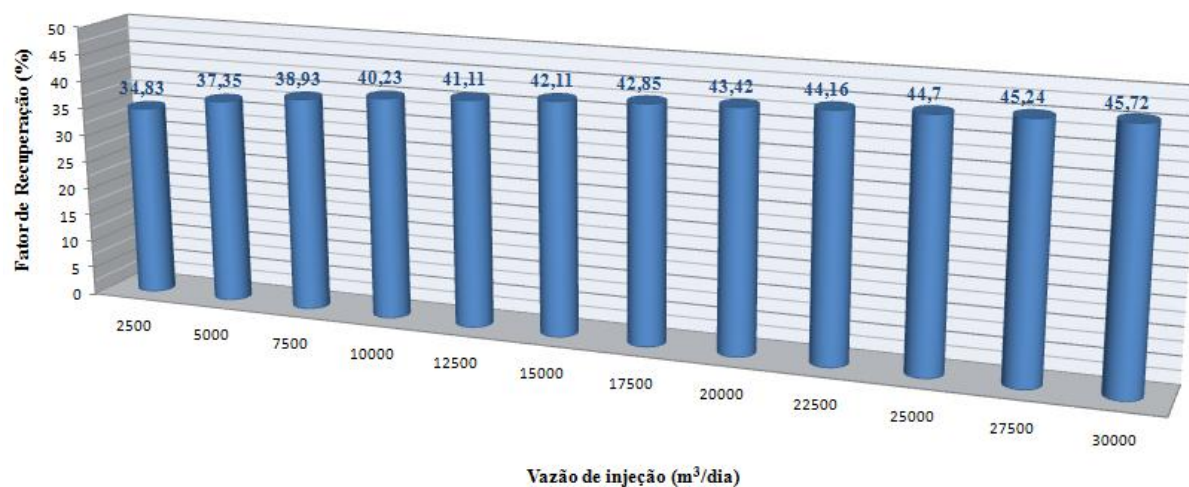
Figura 5.49 - Gráfico da vazão de injeção versus fator de recuperação - Intervalo maior de vazão - Casos B sem capa de gás
