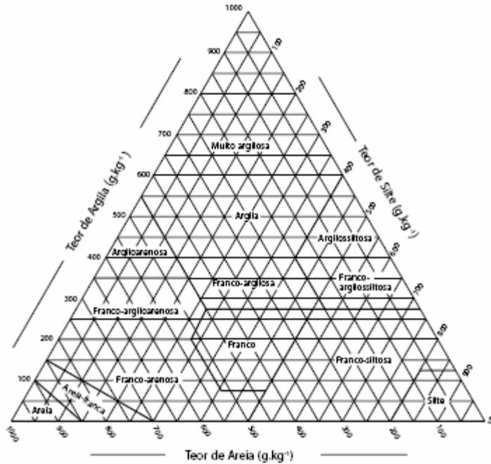
**Figura. 2** Diagrama triangular adaptado utilizado para a classificação textural do solo. Fonte: Manual Técnico de Pedologia – IBGE (2007)
