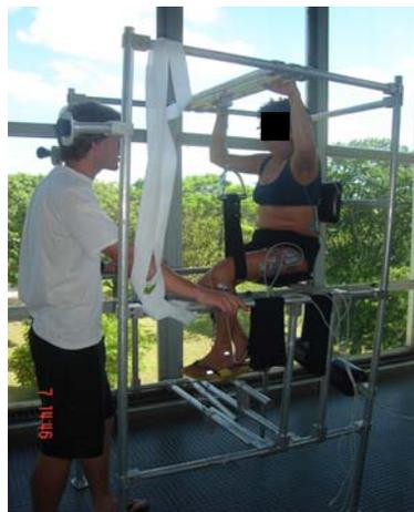
Figura 7: Posicionamento dos indivíduos na gaiola para a realização das CVM's dos músculos reto femoral, bíceps femoral (foto) e gastrocnêmio.
