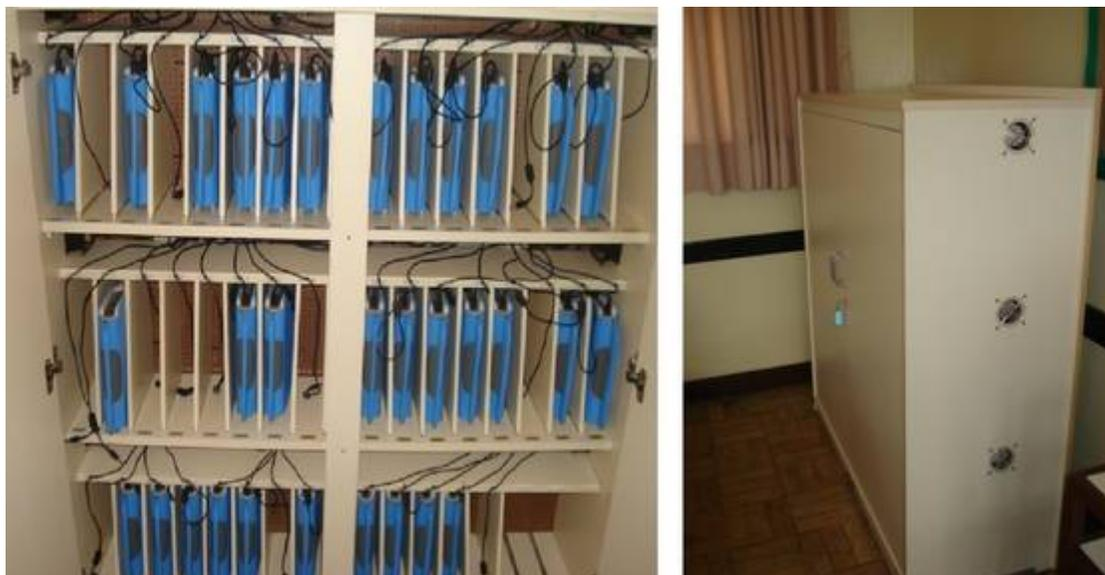
**Figura 05 – Computadores portáteis carregando no armário (esq.) e detalhe dos exaustores laterais para evitar aquecimento excessivo (dir.)**
