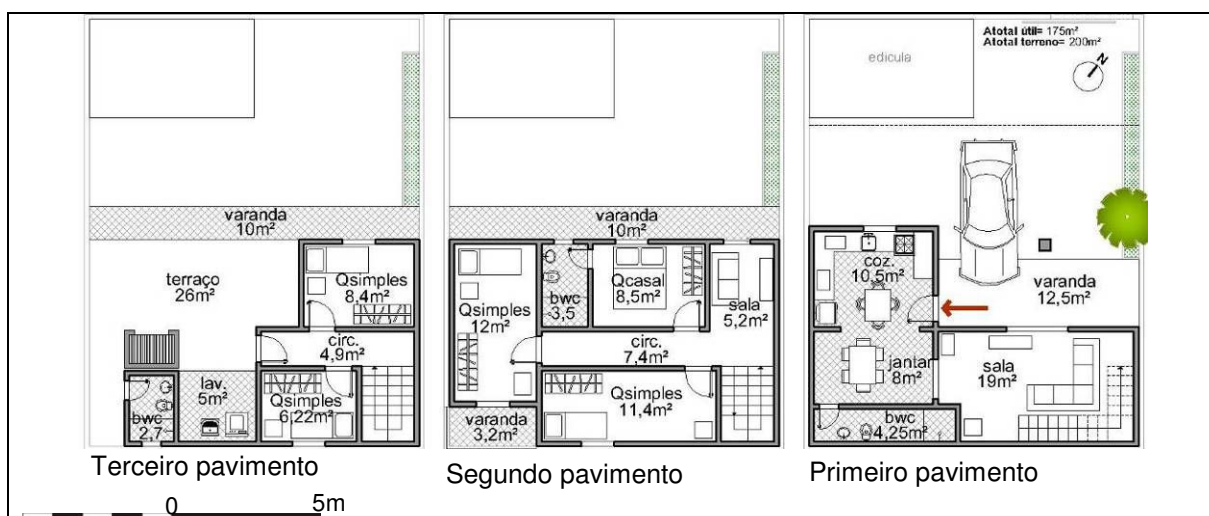
Figura 72: Desenho da planta baixa da moradia do entrevistado número 11 na Vila das Torres – 2009
