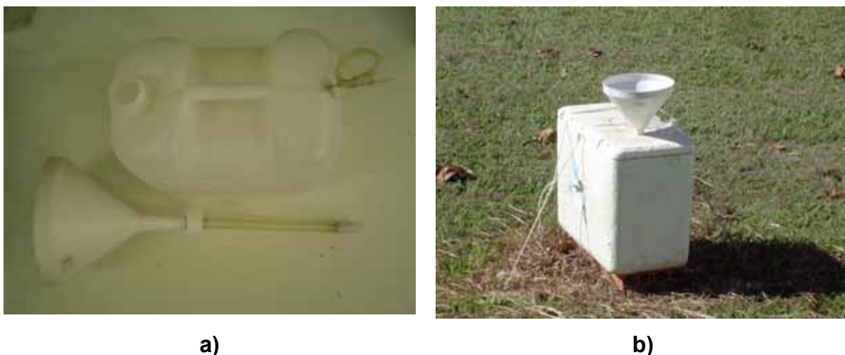
Figura 11 - a) Coletor de precipitação composta desmontado e b) Coletor posicionado dentro da caixa térmica
