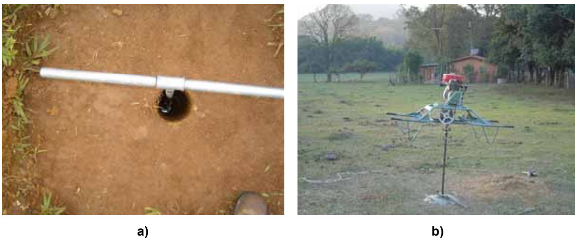
Figura 10 - a) Trado manual ao atingir o aquífero freático e b) Trado mecânico (conjunto motor estacionário/reductor de velocidade posicionados sobre a haste de perfuração)
