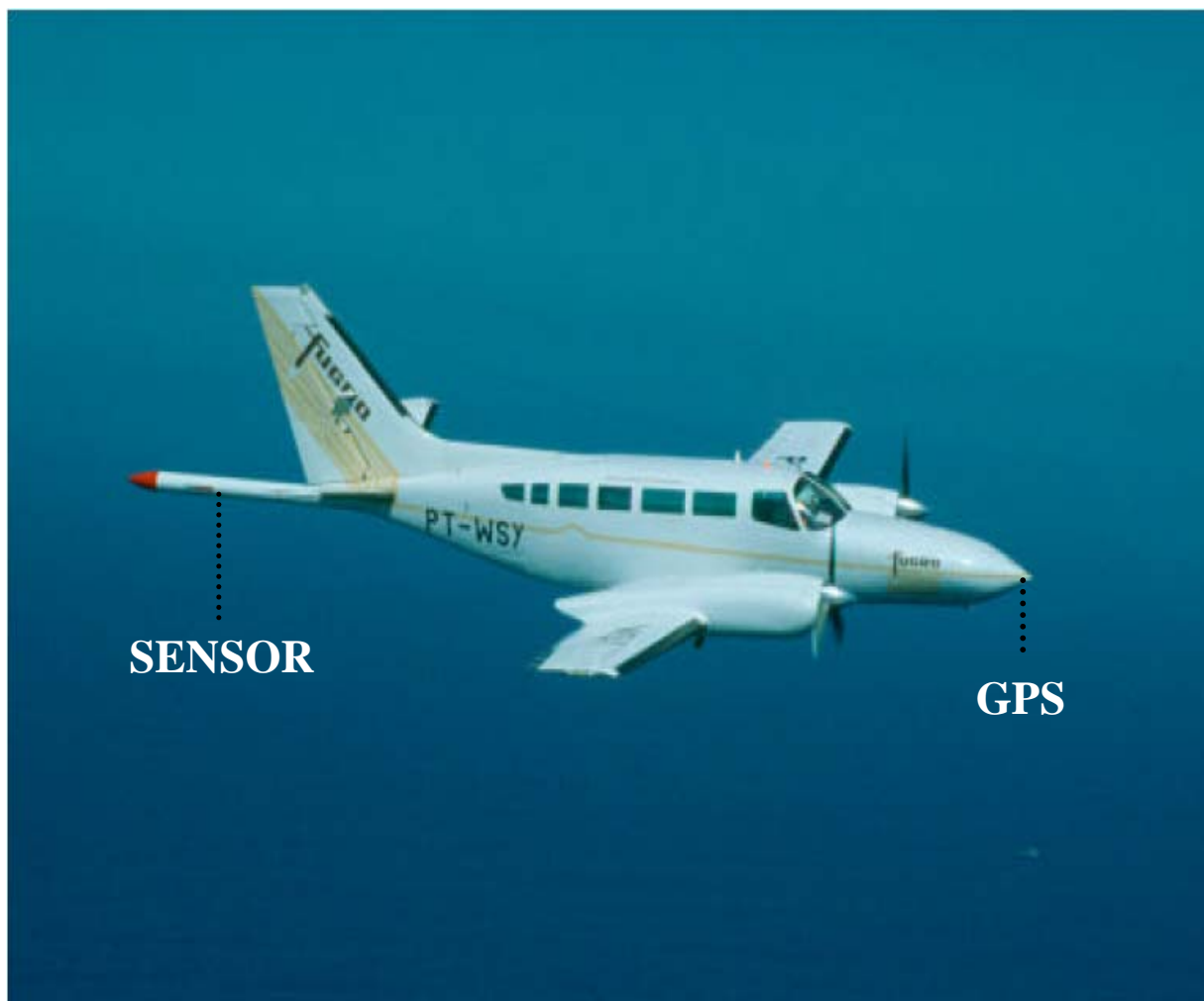
Figura (4.6) Visualização externa da localização da antena GPS e do sensor magnético em uma aeronave.
