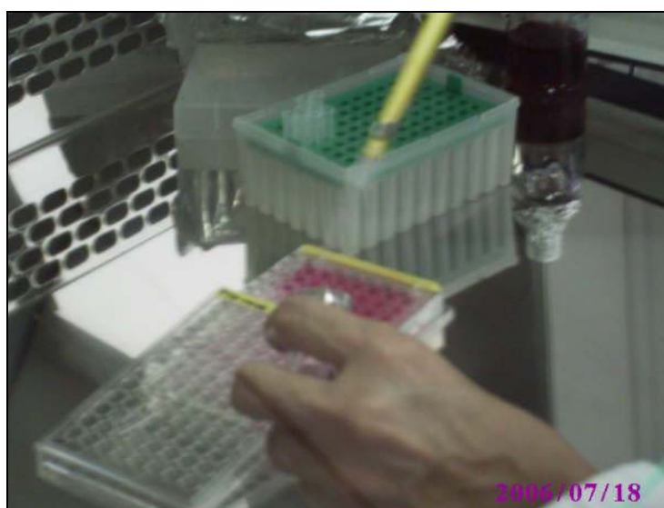
Figura B.03 - Preparo da microplaca para cultura de tecidos e realização do teste de citotoxicidade.
