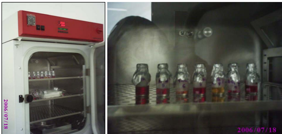
Figura B.01 - Incubadora úmida com atmosfera de CO 2 contendo os frascos com os extratos dos materiais analisados pelo teste de citotoxicidade.
