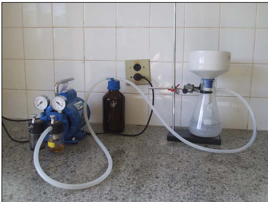
Figura 3.3 - Sistema para absorção a vácuo do líquido das misturas de pós.
