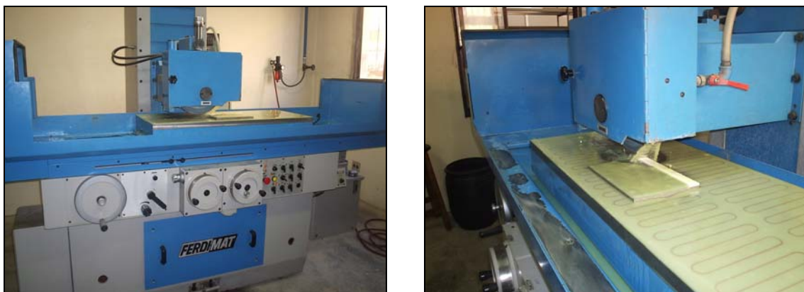
Figura 3.8 - Retífica automática utilizada para preparação superficial das amostras sinterizadas.
