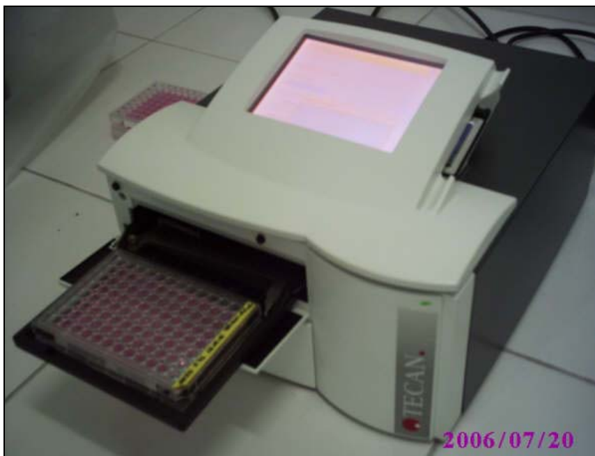
Figura B.04 - Leitor de ELISA com filtro de 540nm e filtro de referência de 620 nm.
