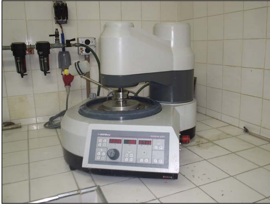
Figura 3.9 - Politriz automática utilizada na preparação dos corpos de provas.
