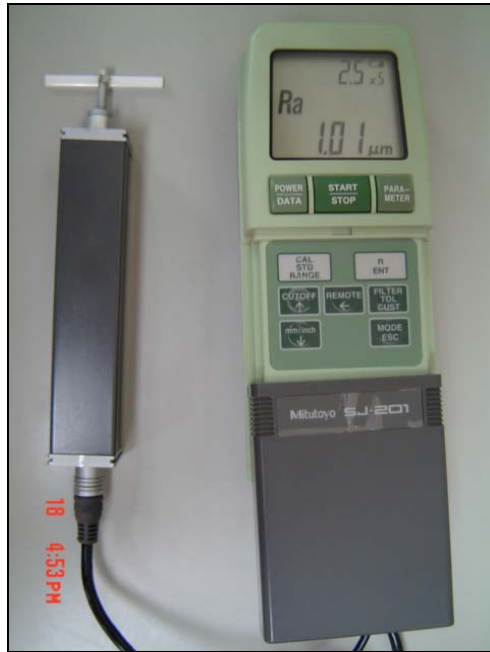
Figura 3.10 - Rugosímetro utilizado na avaliação da superfície 4mm x 45mm, indicando rugosidade média em 3 avaliações de 2,5 μm cada, na direção transversal.
