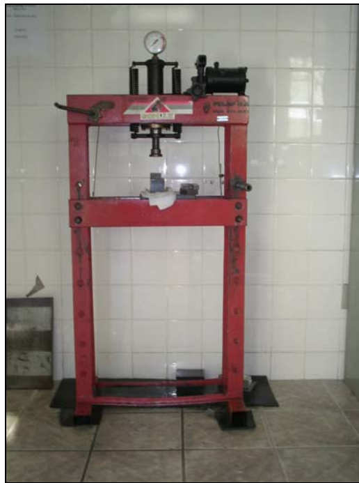
Figura 3.5 - Prensa uniaxial utilizada na etapa de compactação.
