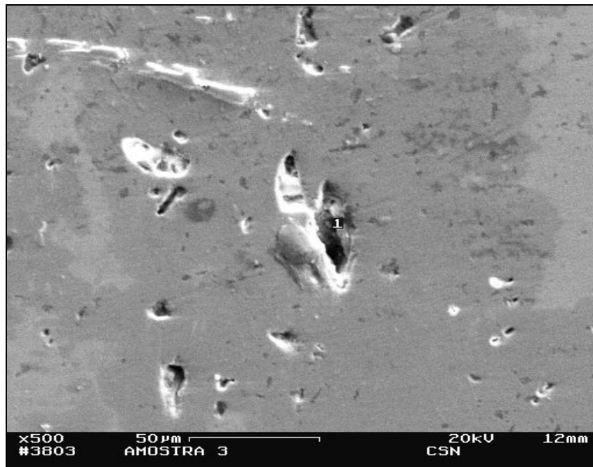
Figura 4.71 - Superfície que foi tracionada em fadiga por flexão, sob fadiga cíclica a 255 MPa em uma amostra com 10% Biovidro, com vida infinita.
