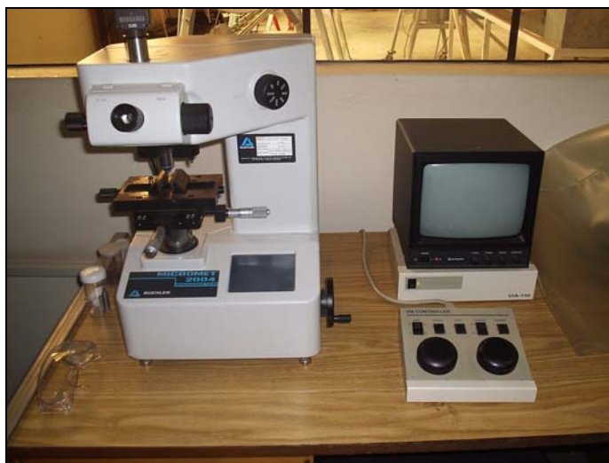
Figura 3.18 - Microdurômetro Micromet 2004, utilizado nas identações Vickers.
