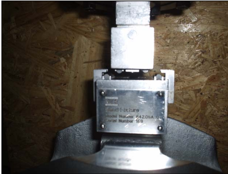
Figura 3.21 - Detalhe do dispositivo de flexão acoplado na Máquina Universal, para ensaios de flexão e/ou fadiga cíclica, em 4 pontos.
