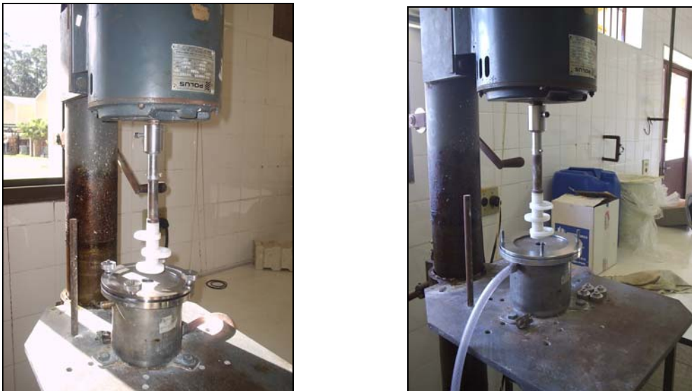
Figura 3.2 - Moinho utilizado na etapa de moagem/homogeneização.
