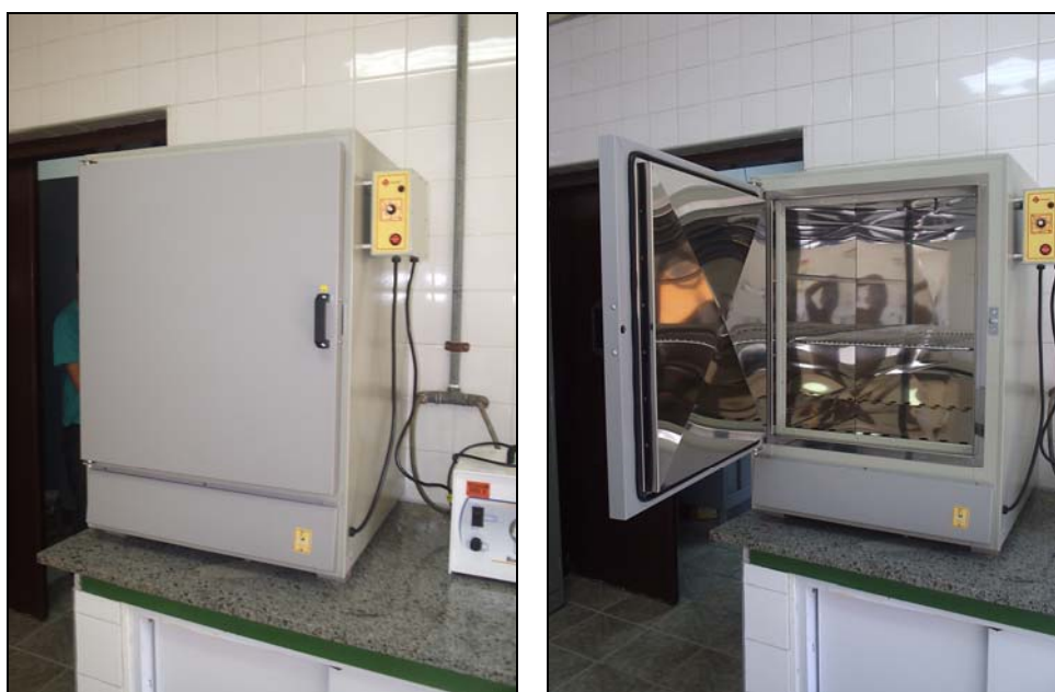
Figura 3.4 - Estufa utilizada na secagem das misturas de pós \text{ZrO}_2(\text{Y}_2\text{O}_3) -Biovidro.
