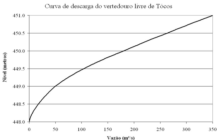
FIGURA 5.16 SÉRIE DE VAZÃO VERTIDA PELO VERTEDOURO LIVRE DE TOCOS
