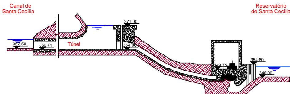
A Barragem de Santa Cecília apresenta comprimento total de 262 m e possui oito comportas de 18,30m e uma com 3,50m de comprimento. A Tabela A1.5 apresenta as características físicas deste reservatório, e a Figura A1.2 ilustra o corte longitudinal deste.
