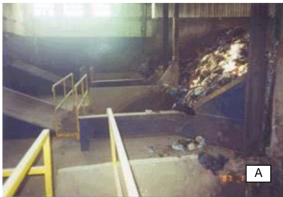
FIGURA 2.5 – USINA DE COMPOSTAGEM DE VILA LEOPOLDINA, SP - SISTEMA DANO: A) CAIXÕES ALIMENTADORES, B) DETALHE DA ENTRADA DO REATOR, C) VISTA EXTERNA DOS REATORES HORIZONTAIS, D) DETALHE DA SAÍDA DO REATOR
