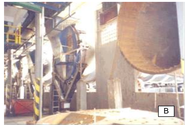
FIGURA 2.5 – USINA DE COMPOSTAGEM DE VILA LEOPOLDINA, SP - SISTEMA DANO: A) CAIXÕES ALIMENTADORES, B) DETALHE DA ENTRADA DO REATOR, C) VISTA EXTERNA DOS REATORES HORIZONTAIS, D) DETALHE DA SAÍDA DO REATOR
