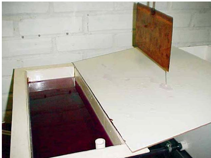
Figura 2.7 – RAMPA DE RESPINGOS REDIRECIONANDO O FLUXO DE VOLTA AO TANQUE
