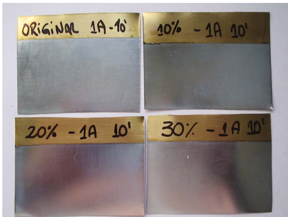
Figura 4.18 – AVALIAÇÃO ÓTICA DOS DEPÓSITOS EM CÉLULA DE HULL COM INTENSIDADE DE CORRENTE 1 A - VISTA DE FRENTE
