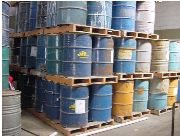
Figura 3.1 – FORMA ADEQUADA DE ACONDICIONAMENTO E ESTOCAGEM DE RESÍDUOS PERIGOSOS
