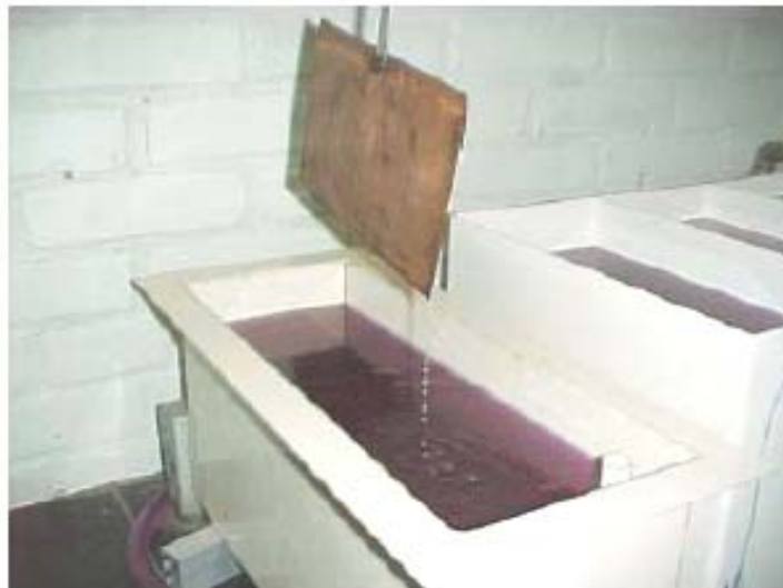
Figura 2.5 – OTIMIZAÇÃO DA FORMA DE PENDURAR AS PEÇAS
