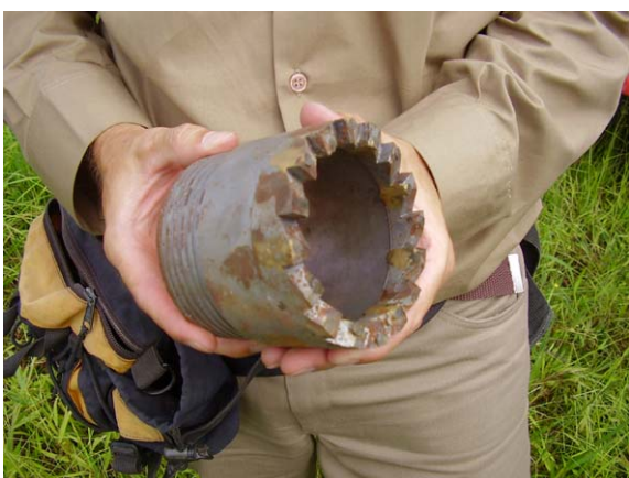
Foto 1 – Diâmetro da broca de perfuração do barrilete-amostrador.
