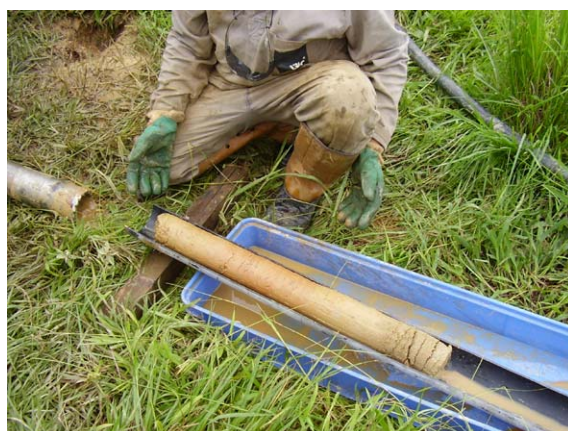
Foto 4 – Aspecto dos testemunhos de sondagem após acondicionamento em segmento de tubo de pvc rígido.
