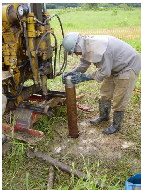
Foto 2 – Retirada de testemunhos de maior diâmetro ( \pm 100\text{mm} ), com o uso de tubo utilizado para encamisar os furos.
