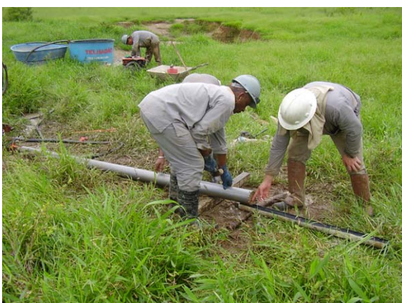
Foto 3 – Processo de retirada dos testemunhos, que são depositados sobre segmentos bipartidos de tubos de pvc rígido.
