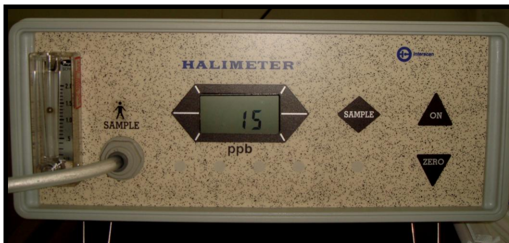
Figura 14. Halímetro (Halimeter ® , Interscan Corp., Chatsworth, CA, USA) marcando 15 ppb antes do bochecho com cisteína (valor inicial).
