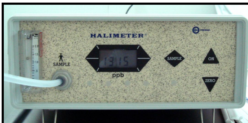
Figura 15. Halímetro (Halimeter ® , Interscan Corp., Chatsworth, CA, USA) marcando 1315 ppb após bochecho com cisteína, demonstrando a indução da halitose (valor pós cisteína).
