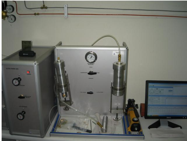
Figura 5.6. Permeabilímetro a gás nitrogênio da marca Core Laboratories Instruments
