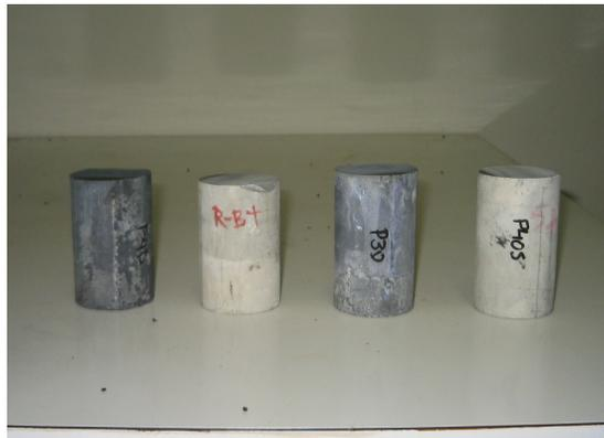
Figura 5.7. Amostras utilizadas para determinação da permeabilidade.
