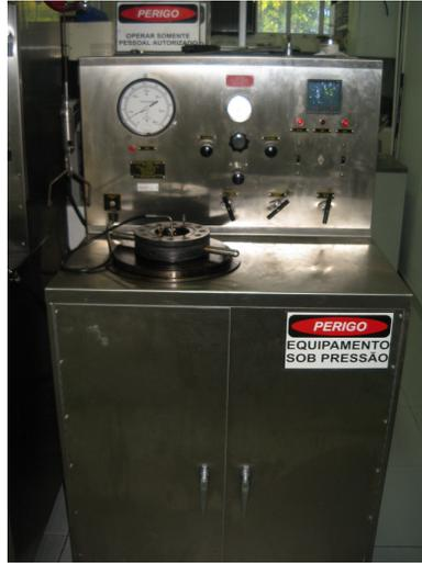
Figura 5.3. Câmara de cura pressurizada.
