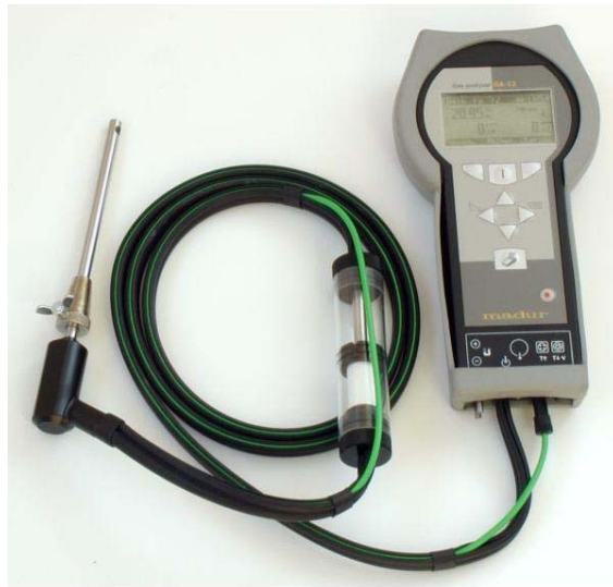
FIGURA 33 – ANALISADOR DE GASES DE COMBUSTÃO TEC-GA12
