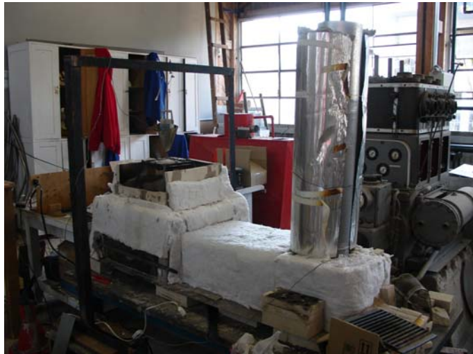
FIGURA 24 – CHAMINÉ DE TIRAGEM NATURAL FONTE: O autor (2008)
