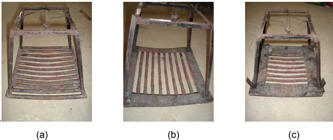
FIGURA 23 – VARIAÇÃO DE ÁREA DE GRELHA UTILIZADA NAS CORRIDAS EXPERIMENTAIS
