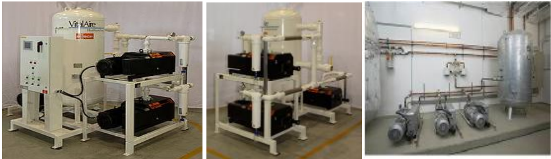
Figura 1.25. Exemplos de sistemas de vácuo clínico dotados de bombas de palhetas rotativas. Fonte: http://www.buschdobrasil.com.br , acesso em 21/07/2009.
