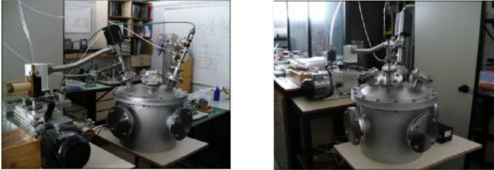
Figura 8.6 – Sistema de pré-vácuo formado por câmara de vácuo de 46 litros, fole metálico de 48 cm de comprimento e 3,5 cm de diâmetro, válvula solenóide, coluna de mercúrio, medidor Pirani e bomba de vácuo com velocidade de bombeamento 8 \text{ m}^3/\text{h} . Fonte: LTV da FATEC-SP (2008).
