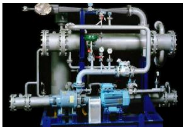
Figura 2.12. Protótipo de um sistema de pré-vácuo híbrido, formado por ejetor de vapor, condensador casco/tubo intermediário e bomba de anel líquido com circuito fechado de líquido de selagem. Fonte: http://www.gardnerdenvernash.com.br/pdf/ejetor.pdf acesso em 02/01/2009.
