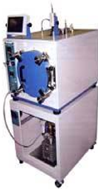
Figura 1.2 – Estufa de secagem a vácuo. Incorpora câmara de trabalho de chapa de aço inoxidável AISI 304 para aquecimento a seco, porta de aço inoxidável AISI 304 com vedação hermética por guarnição de silicone, dois visores de vidro temperado de 20 mm, sistema de captura de imagem com câmera de vídeo e monitor de cristal líquido de 7" e dois registros instalados na parte superior, um para adição de resina e outro para aplicação de nitrogênio na amostra. Disponível em: www.marconi.com.br , acesso em 12/12/2008.
