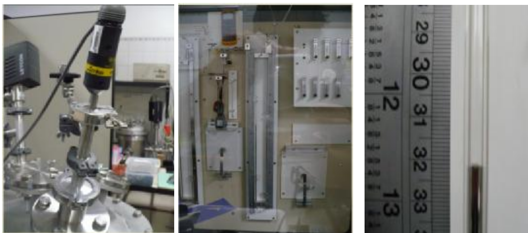
Figura 8.9 Coluna de mercúrio (no centro), filmagem do decaimento de pressão (à direita) e cabeça sensora do medidor de pressão Pirani (à esquerda). Fonte: LTV FATEC-SP.
