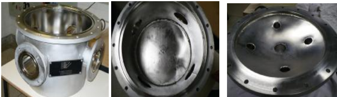
Figura 8.1 Partes da câmara de vácuo de 46 litros, mostrando acabamento interno por eletropolimento. Fonte: PrestVácuo (2008)
