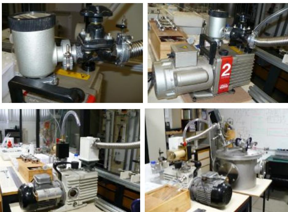
Figura 8.4 Montagem dos filtros de admissão e exaustão nas bombas mecânicas utilizadas no estudo de caso. Fonte: LTV - FATEC – SP (2008).
