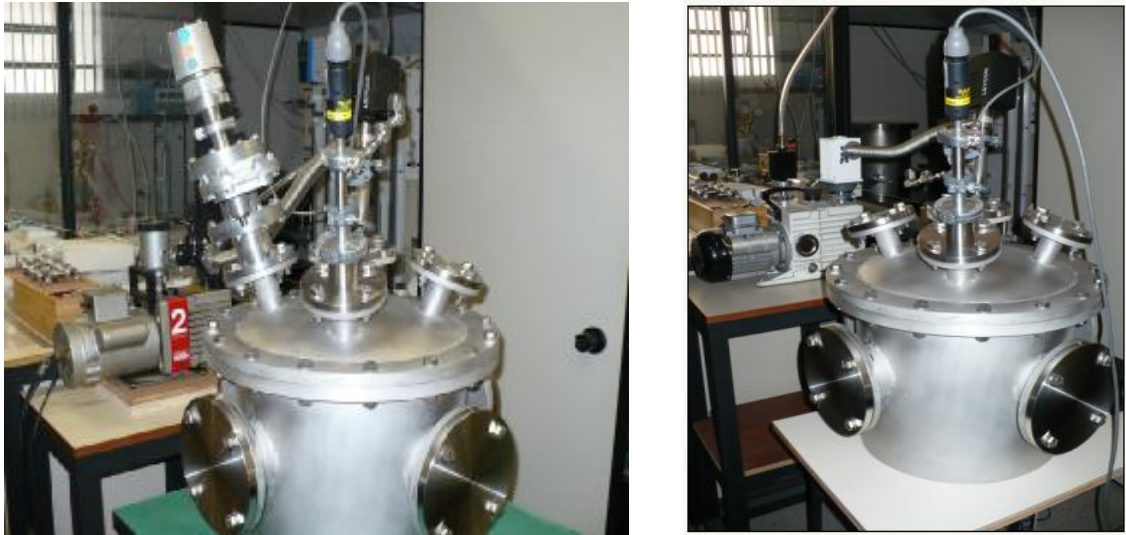
Figura 8.5 – Bombas de vácuo utilizadas em dois sistemas de pré-vácuo empregados no estudo de caso: Sb 2 m 3 /h (lado esquerdo) e Sb 8 m 3 /h (lado direito). Fonte: LTV da FATEC-SP (2008).
