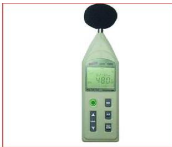
Figura 8.7 – Decibelímetro digital da marca Instrutherm Modelo DEC 5000, com escala de 30 a 130 dB, precisão +/- 1,5 dB e resolução de 0,1 dB e ponderação A e C. Fonte: Instrutherm, disponível em www.Instrutherm.com.br , acesso em 29/01/2009.
