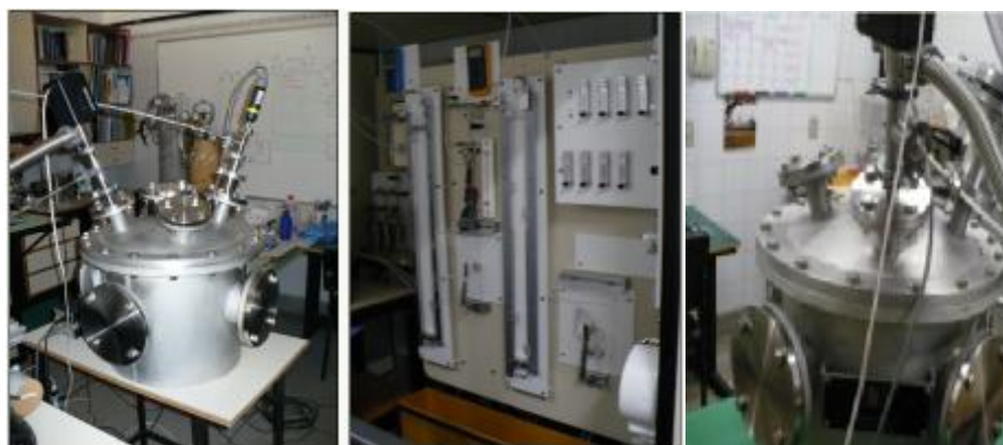
Figura 8.3 Montagem do medidor Pirani,coluna de mercúrio, válvula solenóide e folie metálico. Fonte: Laboratório de Tecnologia do Vácuo da FATEC-SP (2008).
