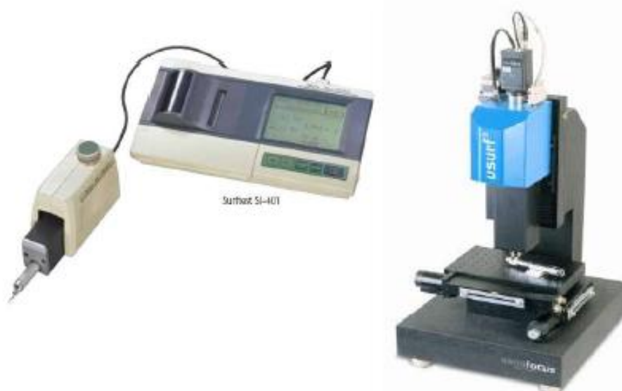
Figura 5.7 – Exemplos de rugosímetros utilizados para avaliar a qualidade de superfícies usinadas. Fonte: Stoeterau (2007).
