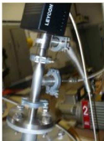
Figura 8.8 Válvula de acionamento eletrônico utilizada nos experimentos. Fonte LVT-FATEC (2008).
