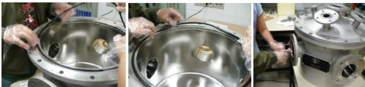
Figura 8.2 – Diferentes etapas da montagem da câmara de vácuo. Fonte: Laboratório de Tecnologia do Vácuo da FATEC-SP (2008).
