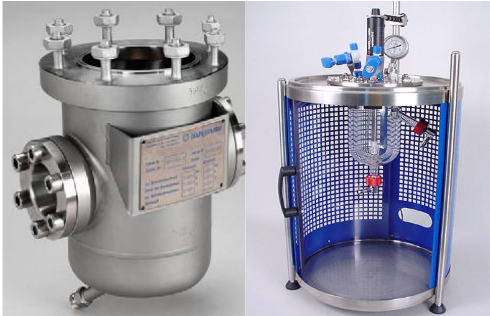
Figura 2.3 - Vasos de pressão que obedecem a critérios de segurança conforme NR 13 da ABNT. À esquerda vaso de pressão com placa de identificação contendo ano de fabricação, fabricante, pressão máxima de trabalho admissível, temperatura máxima e mínima de operação, código do projeto e ano de edição. À direita vaso de pressão, com proteção feita de tela metálica perfurada, contra colapso, implosão ou explosão. Fonte: http://www.buchiglas.ch/english/products/stirredautoclaves/inertclaves.cfm , acesso em 24/12/2008.
