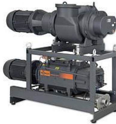
Figura 2.10. – Sistema de bombeamento combinando bomba mecânica de palhetas de duplo estágio e bomba Roots, que permite pressão final 10^{-3} mbar e velocidade de bombeamento 4000 \text{ m}^3/\text{h} . Fonte: www.buschdoBrasil.com.br/roots.htm , acesso em 02/01/2009.
