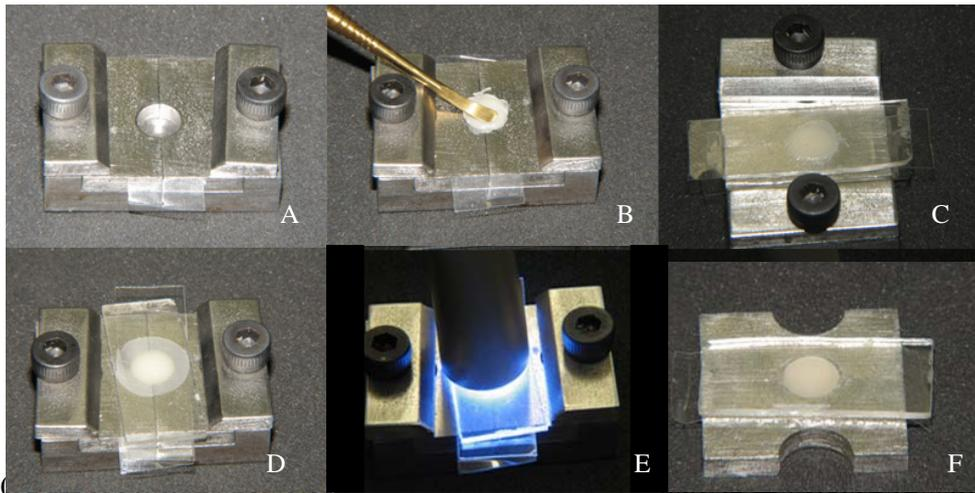
**Figura 1** ( ) - aplicação da resina na matriz; C- aplicação de tira de poliéster e lâmina de vidro sobre a resina; D- após pressão para extravasamento dos excessos, E- fotoativação; F- remoção de parte da matriz para fotoativação do lado oposto
