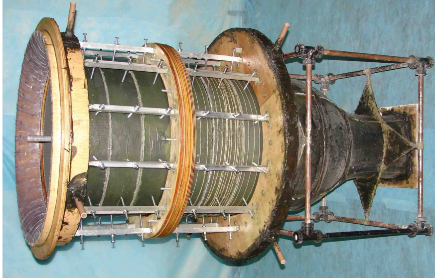
Figura 5.7: Conjunto retificador do túnel de vento montado com a contração.
