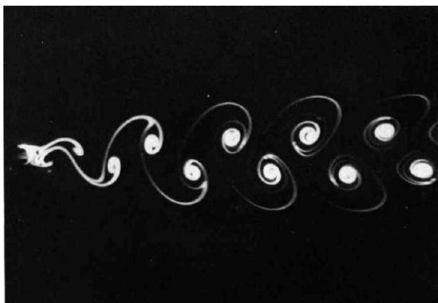
**Figura 2.9 – Escoamento ao redor de um cilindro circular,  $Re = 105$ . Extraído de VAN DYKE (1982)**
