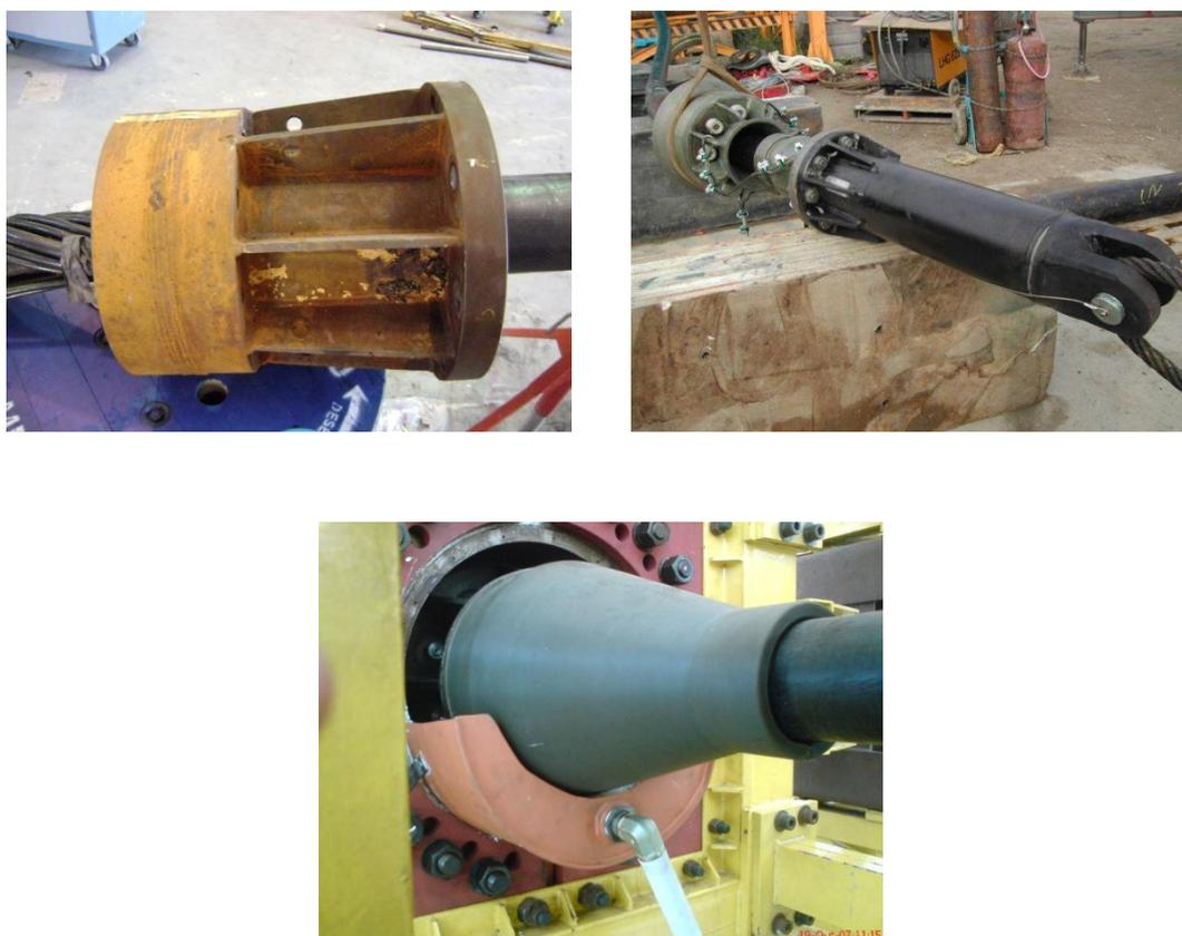
**Figura 1.10 – Exemplos de acessórios. Da esquerda para a direita, de cima para baixo: armour pot, cabeça de tração e enrijecedor de curvatura**
