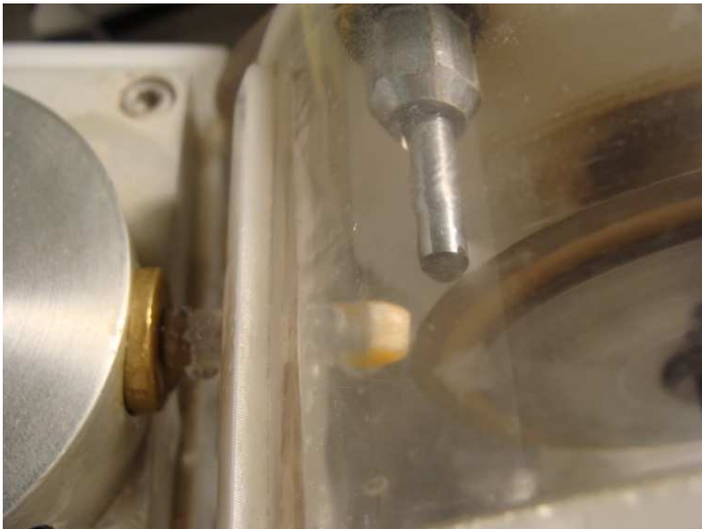
Figura 4.23 - Close do espécime sendo seccionado
