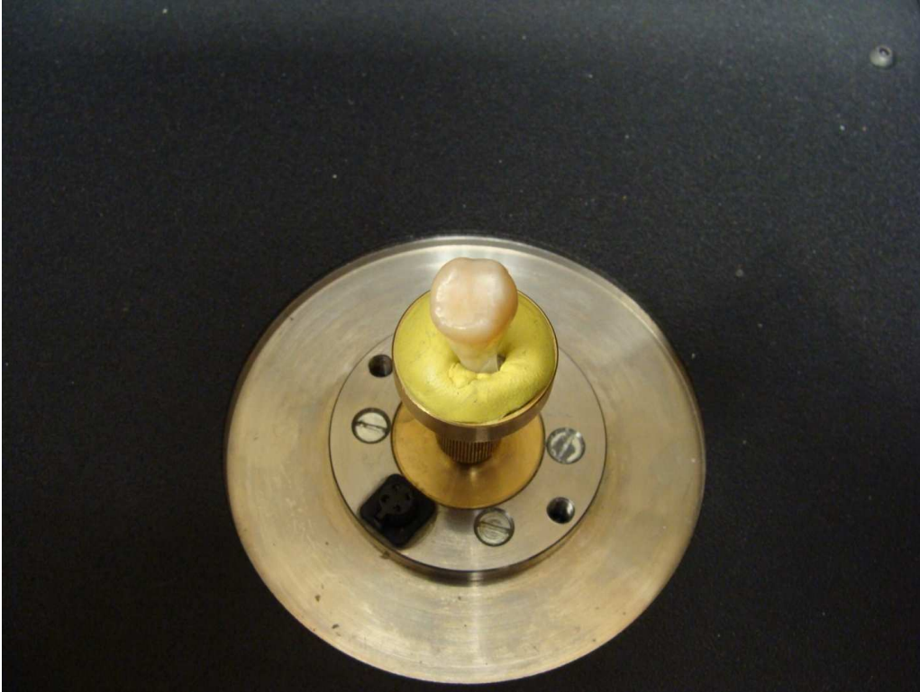
Figura 4.3 - Detalhe do espécime enrolado em parafilme
