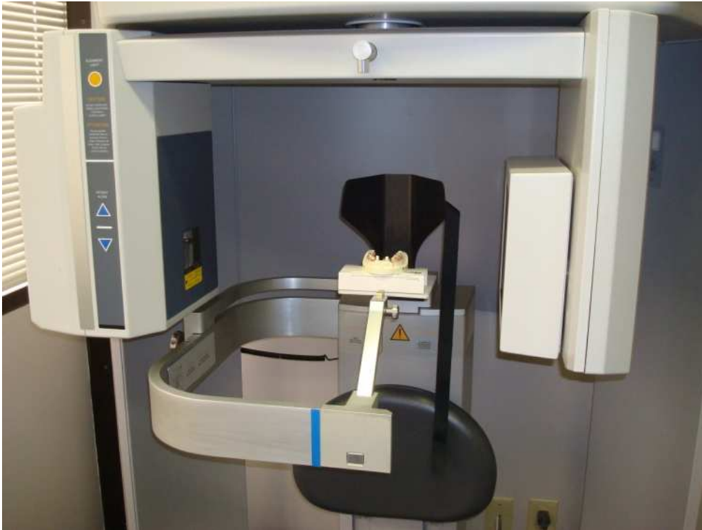
Figura 4.10 - Modelo em posição para a execução da CBCT
