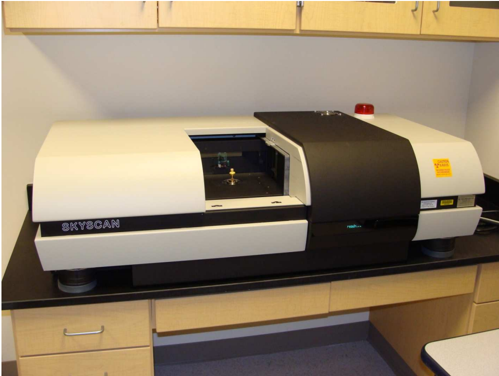
Figura 4.1 - Equipamento de \mu CT Skyscan 1172 (Bruxelas, Bélgica)
