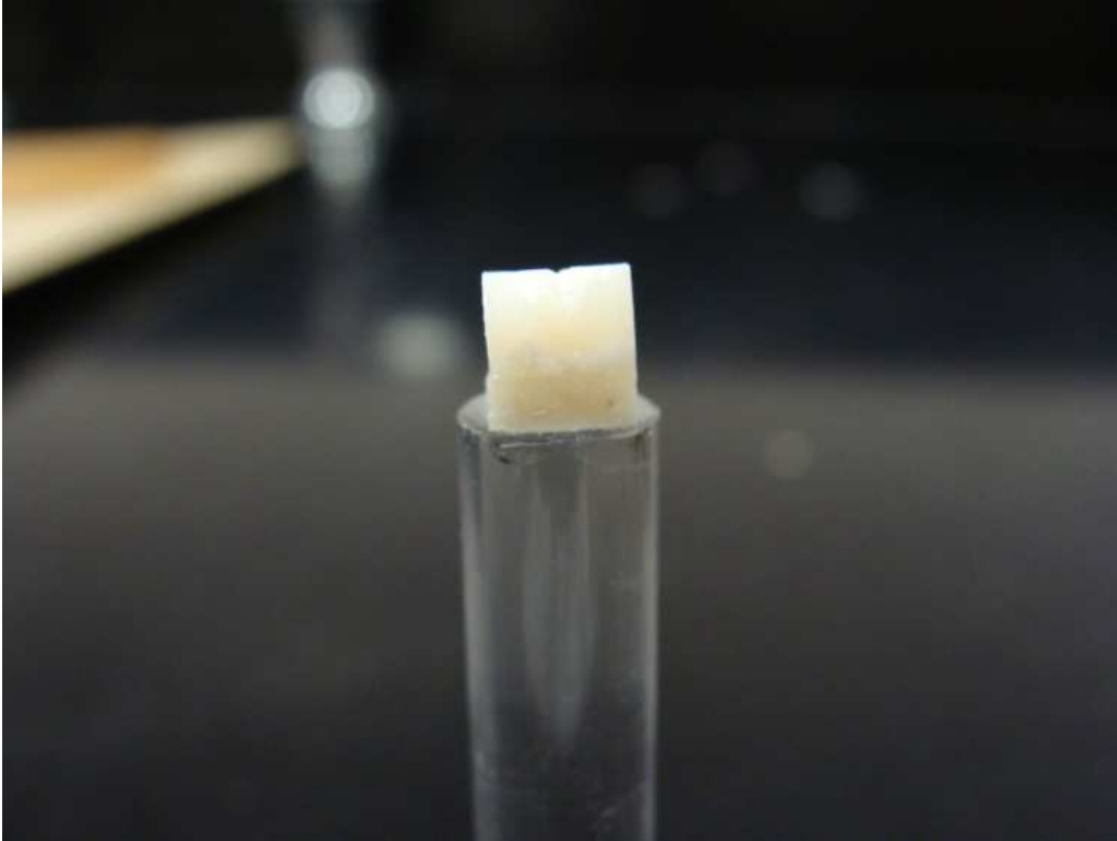
Figura 4.16 - Detalhe de um espécime cortado para se realizar os cortes de 100 \mu m
