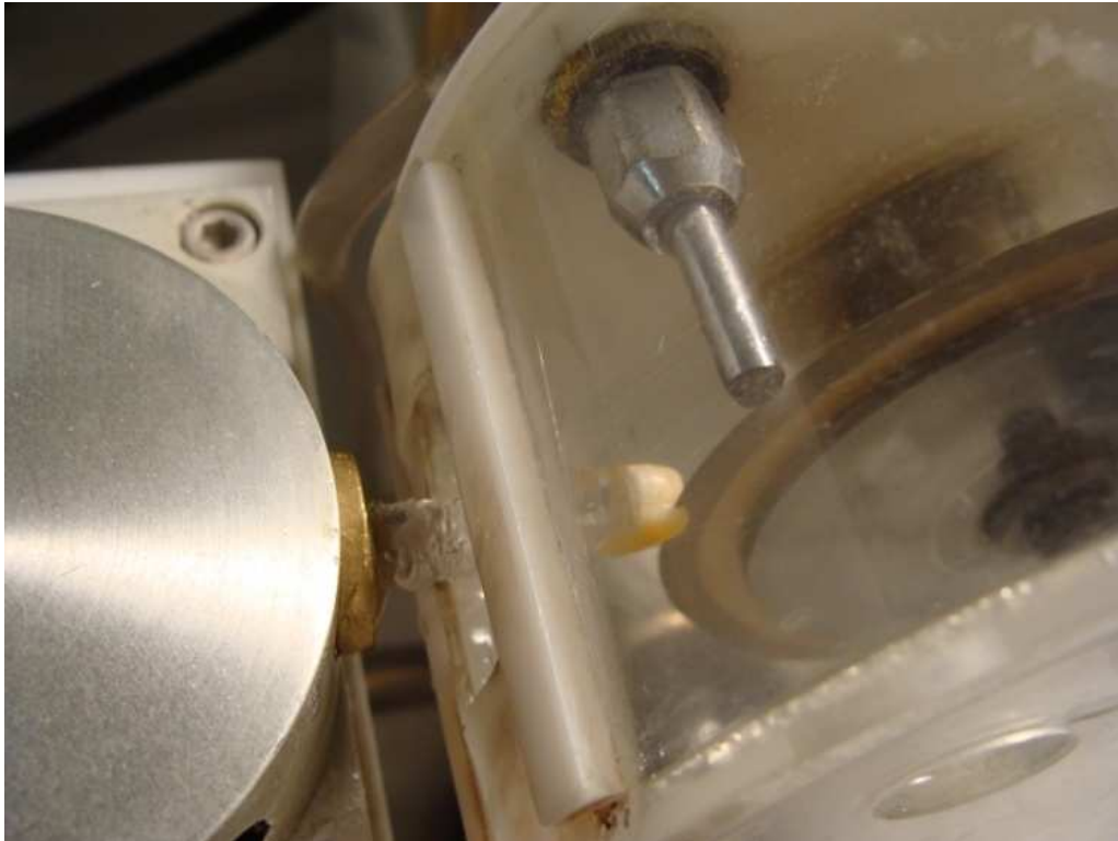
Figura 4.24 - Lâmina do micrótomo cortando o dente
