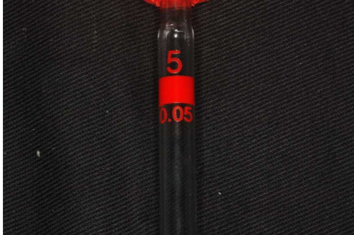
Figura 4.10 - Pipeta graduada com precisão de 0,05ml
