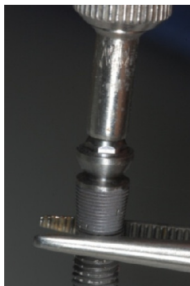
Figura 19 – Implante CM recebendo o torque
