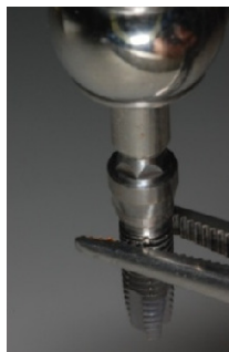
Figura 13 – Implante HE recebendo o torque
