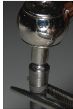
Figura 16– Implante HI recebendo torque
